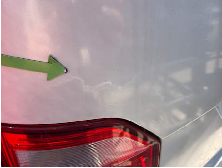
Heckklappe (Unsachgemäß instand gesetzt)
