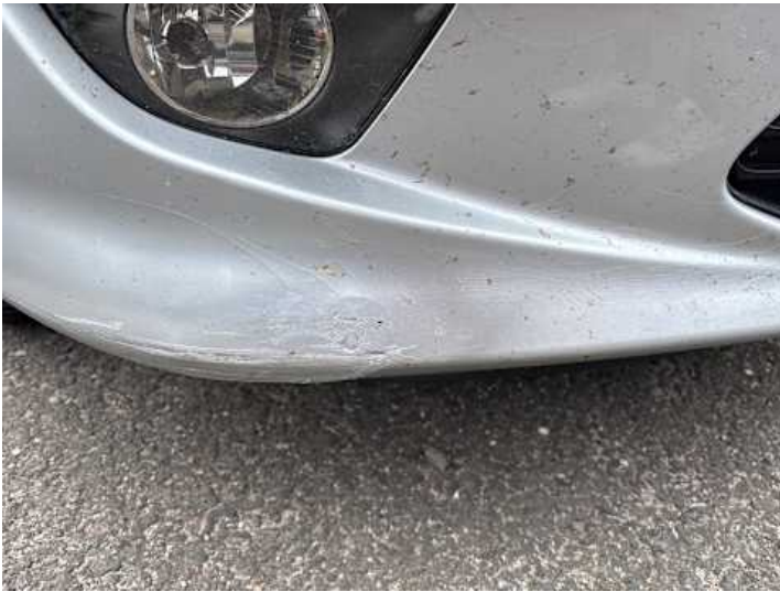
Stoßstange vorne (Riss/Bruch, Kratzer)
