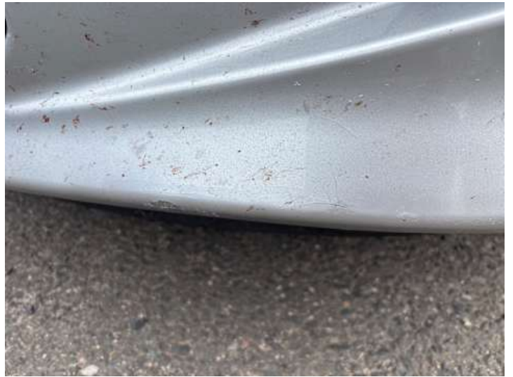
Stoßstange vorne (Riss/Bruch, Kratzer)
