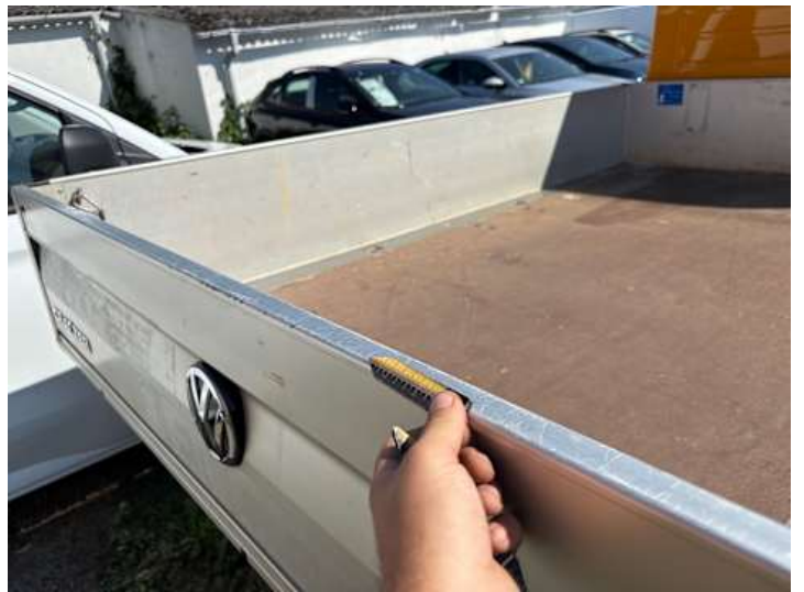
Heckklappe (Lackschaden, Kratzer)
