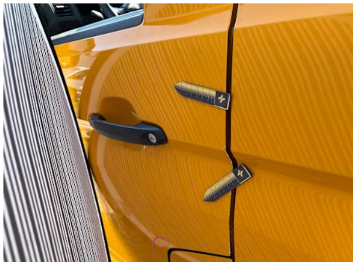
Fahrtür (Delle, Lackschaden)
