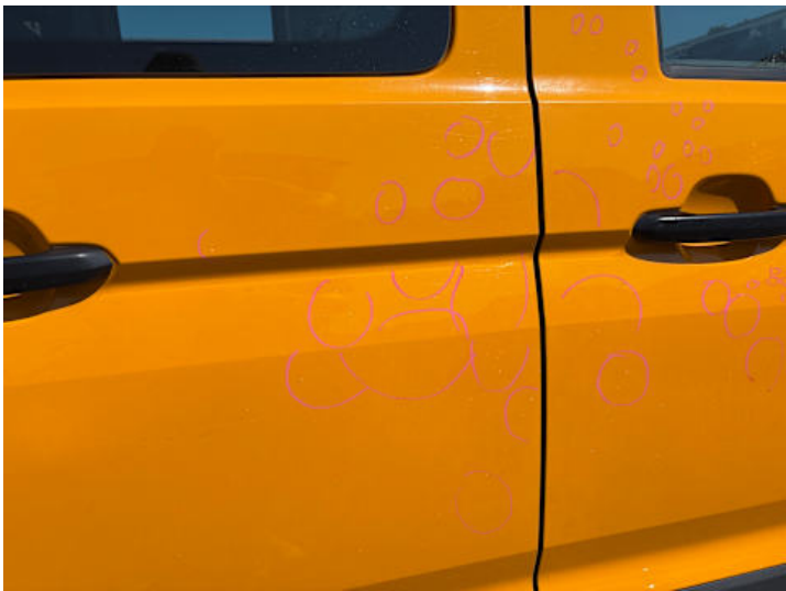
Türe hinten rechts (Lackschaden)
