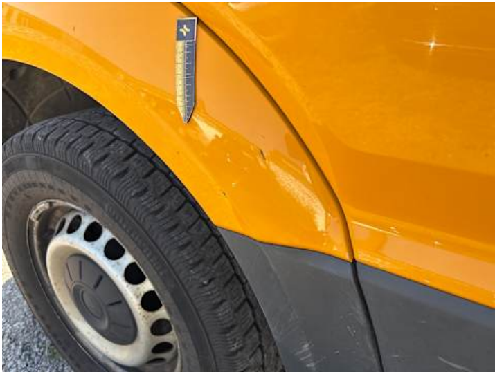
Kotflügel vorne links (Ausgeblichen/Matt)
