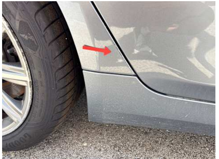
Seitenteil hinten rechts (Steinschlag)
