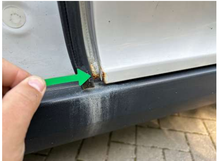
Türe hinten links (Rost)
