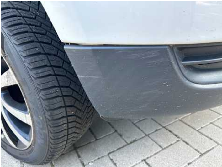
Stoßstange vorne (Kratzer, Spaltmaße ungenau)
