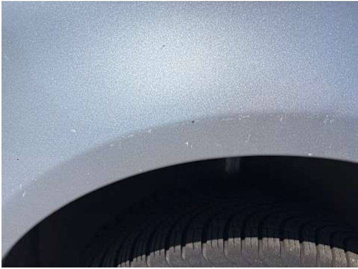
Kotflügel vorne rechts (Delle, Kratzer)
