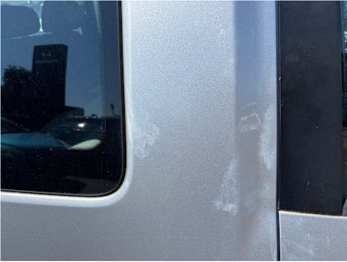
Türe hinten rechts (Kratzer, Lackschaden)
