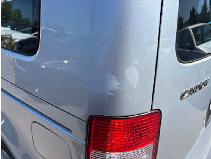
Seitenteil hinten links (Lackschaden, Kratzer)
