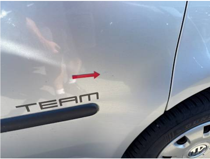
Türe hinten links (Kratzer, Lackschaden, Delle)
