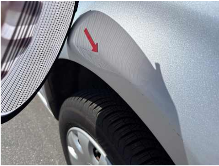
Kotflügel vorne rechts (Delle, Kratzer)
