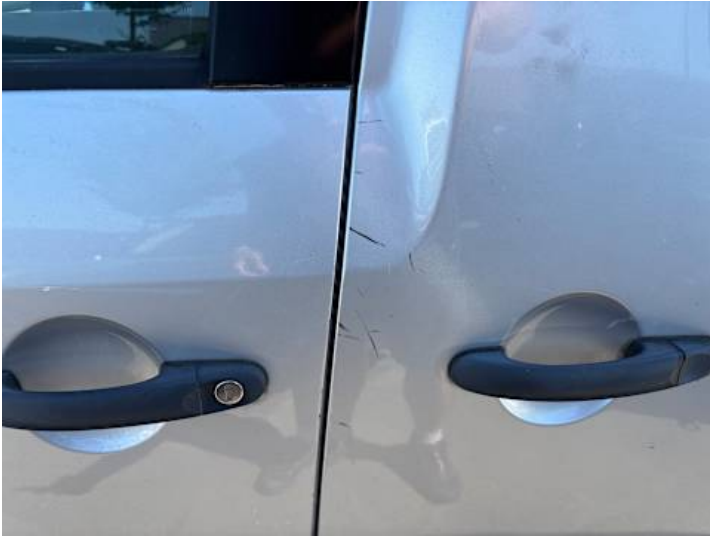
Türe hinten links (Kratzer, Lackschaden, Delle)
