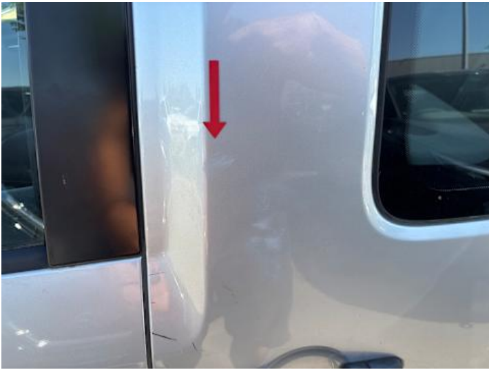
Türe hinten links (Kratzer, Lackschaden, Delle)
