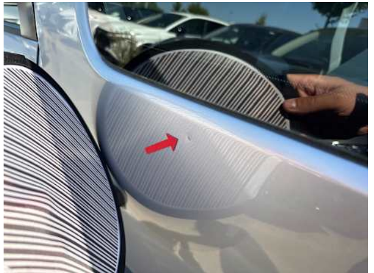
Türe hinten links (Kratzer, Lackschaden, Delle)
