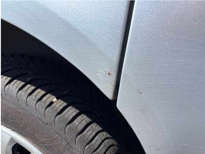
Seitenteil hinten rechts (Rost, Kratzer)
