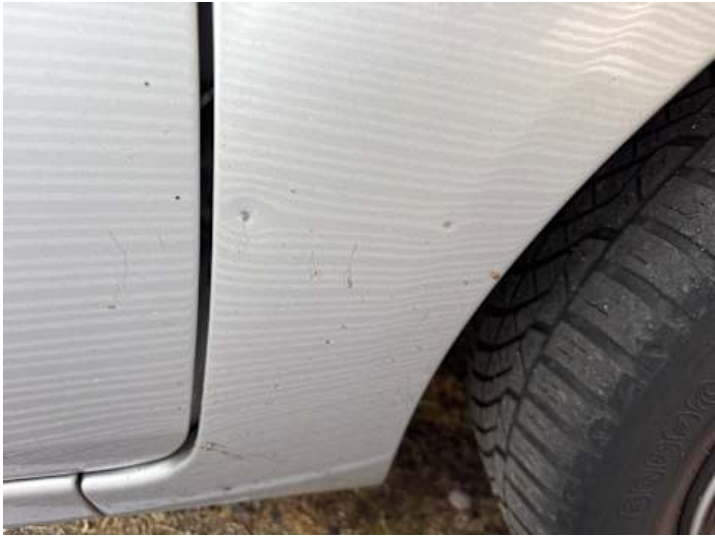
Kotflügel vorne rechts (Kratzer, Delle)
