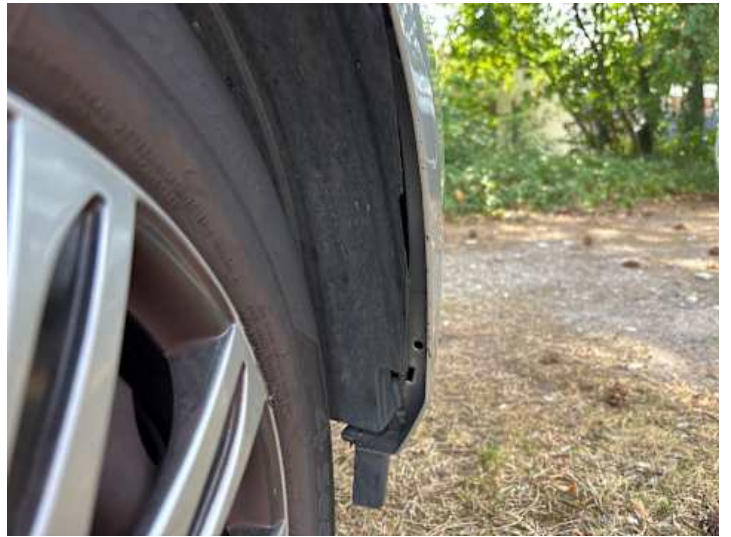
Stoßstange vorne (Riss/Bruch, Kratzer)
