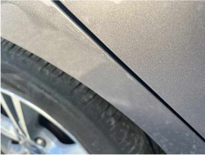
Seitenteil hinten rechts (Lackschaden)
