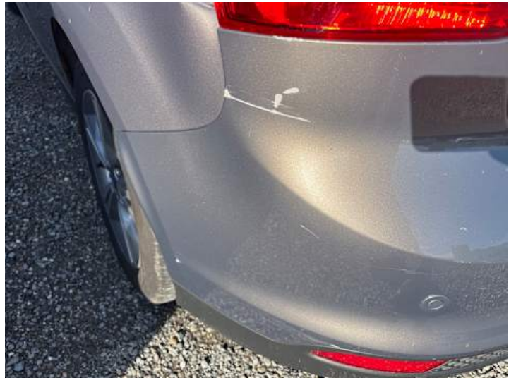
Stoßstange hinten (Lackschaden)
