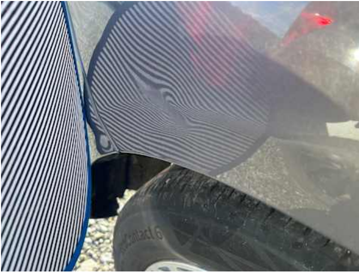
Seitenteil hinten rechts (Delle, Lackschaden)
