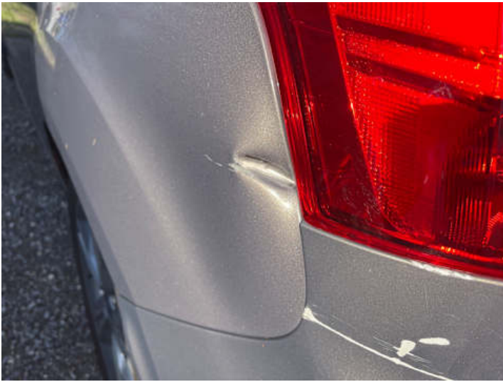
Seitenteil hinten links (Lackschaden, Verformung)
