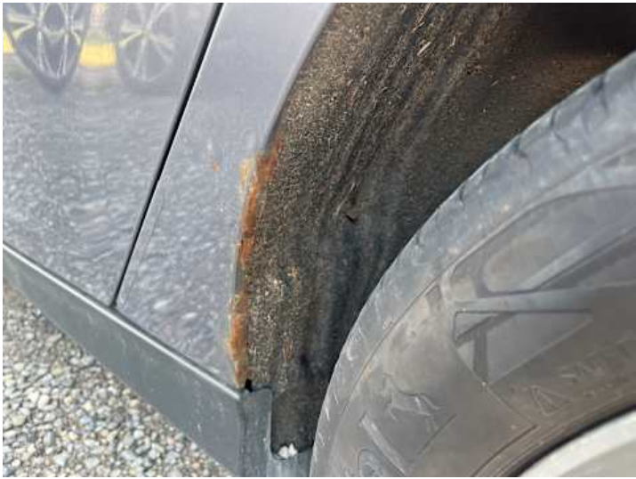
Seitenteil hinten links (Rost)
