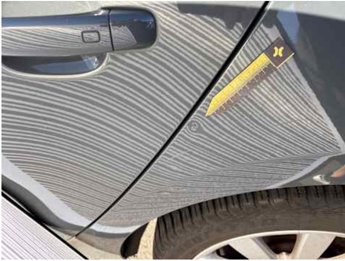
Seitenteil hinten links (Kratzer, Delle)
