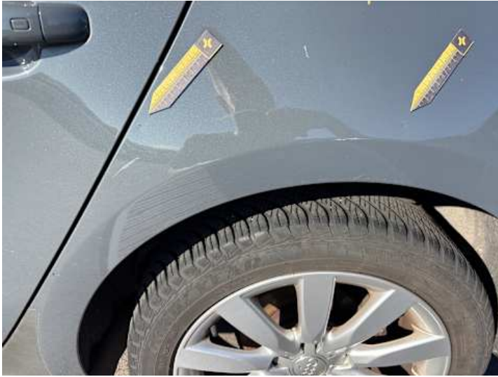
Seitenteil hinten links (Kratzer, Delle)
