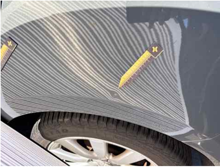
Seitenteil hinten links (Kratzer, Delle)
