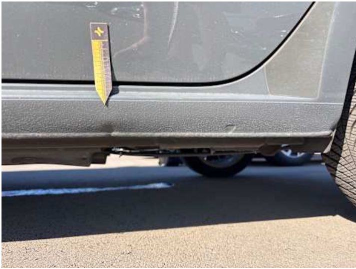
Schweller links (Verformung)
