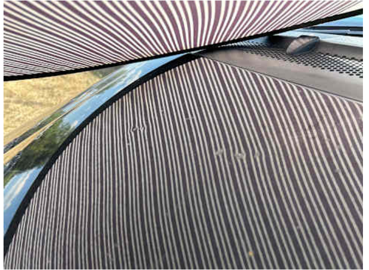
Motorhaube (Delle, Lackschaden)
