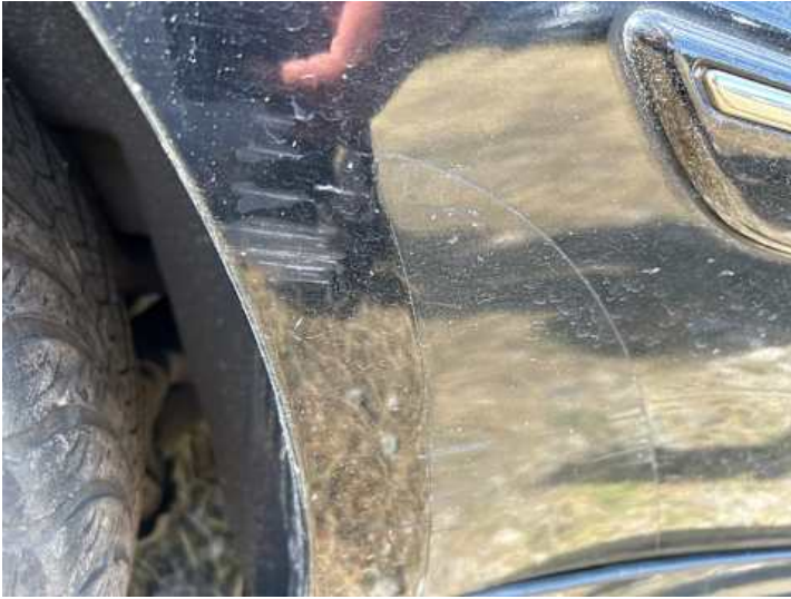
Seitenteil hinten rechts (Kratzer)
