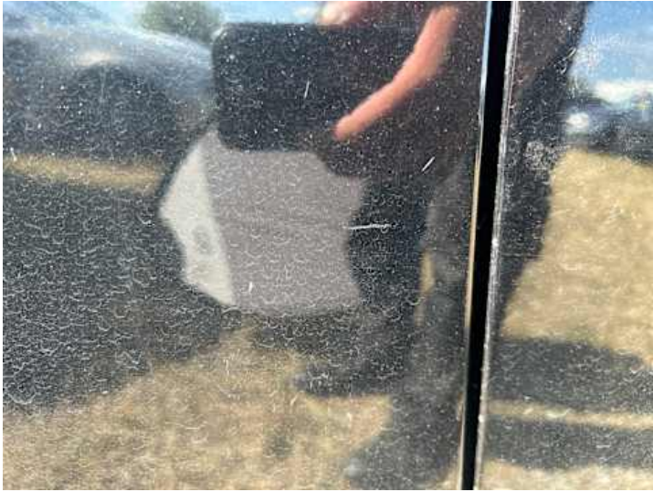
Seitenteil hinten rechts (Kratzer)
