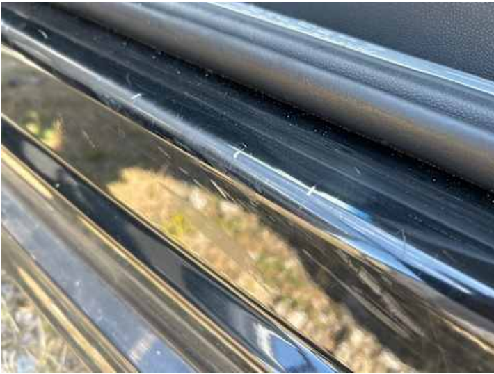
Schweller links (Lackschaden)
