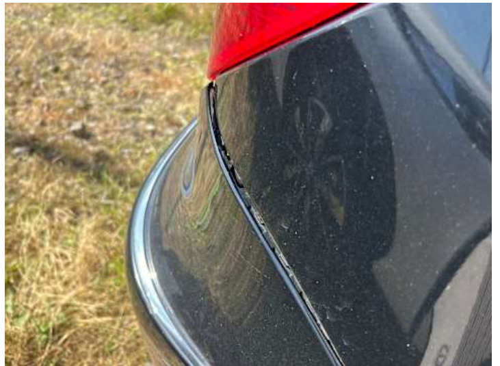
Stoßstange hinten (Spaltmaße ungenau)
