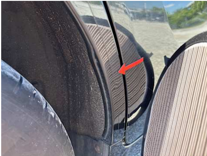
Seitenteil hinten rechts (Delle)
