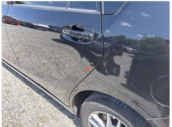
Türe hinten links (Delle)
