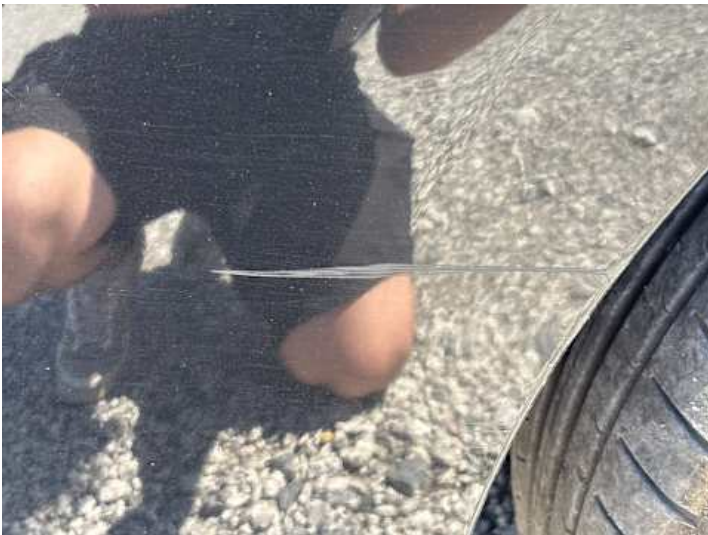
Stoßstange vorne (Kratzer, Lackschaden)
