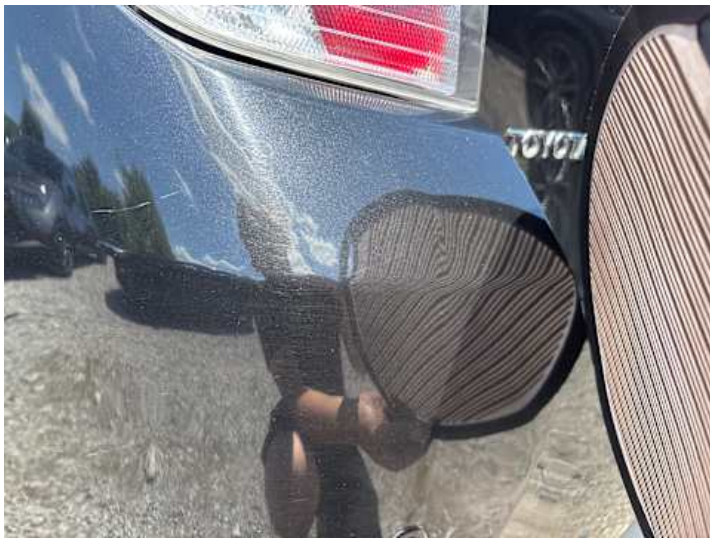
Stoßstange hinten (Delle, Verformung)
