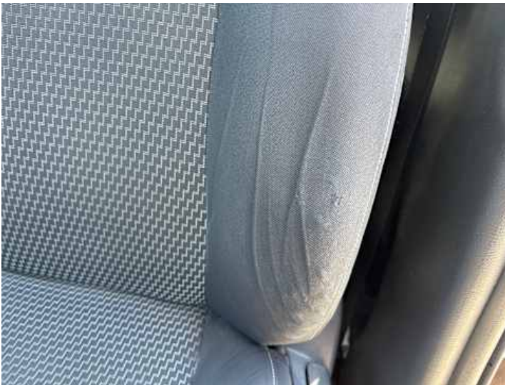
Innenraum (Verschleiß, Kratzer)
