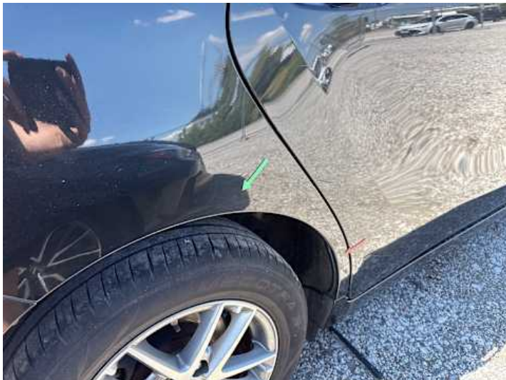
Seitenteil hinten rechts (Delle)
