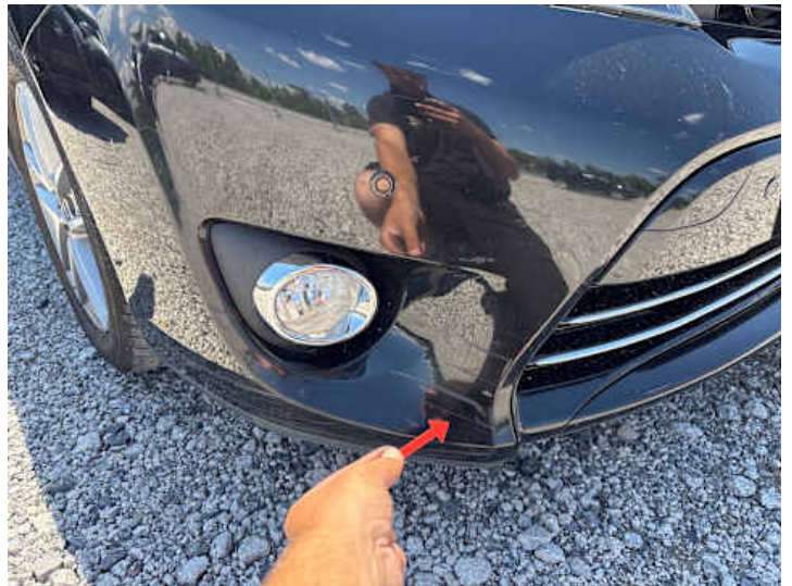
Stoßstange vorne (Kratzer, Lackschaden)
