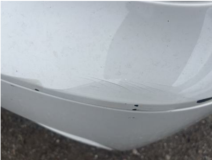
Stoßstange vorne (Verformung, Riss/Bruch)
