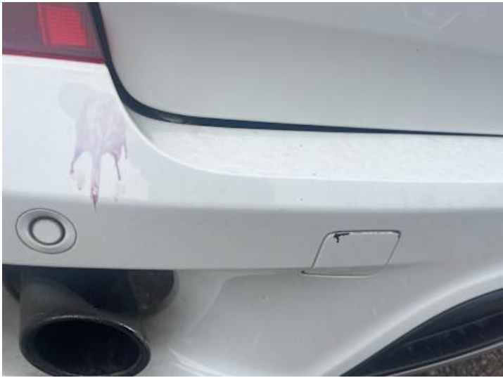
Stoßstange hinten (Lackschaden)
