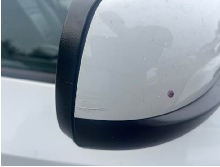
Beifahrertür (Lackschaden, Unsachgemäß instand gesetzt)
