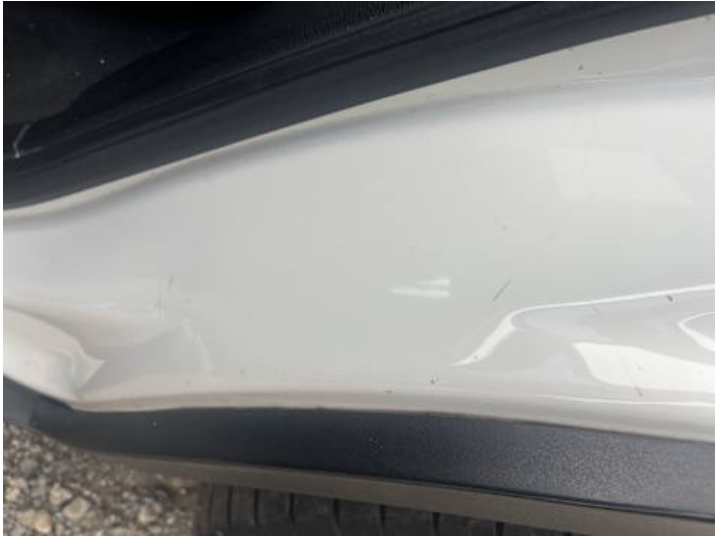
Türe hinten links (Kratzer, Lackschaden)
