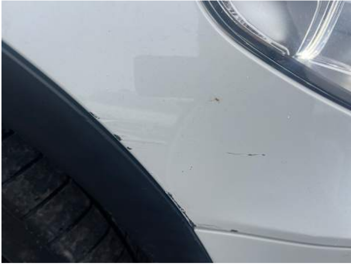
Kotflügel vorne rechts (Kratzer, Lackschaden)
