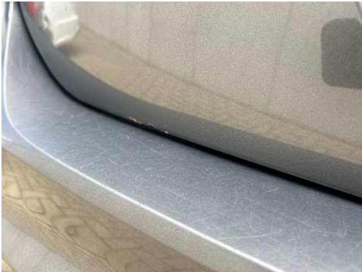
Heckklappe (Kratzer, Rost)
