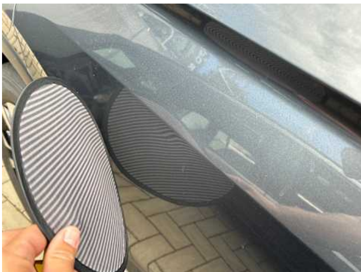
Türe hinten rechts (Verformung)
