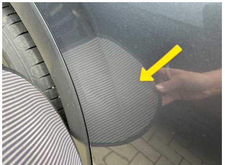
Türe hinten rechts (Verformung)
