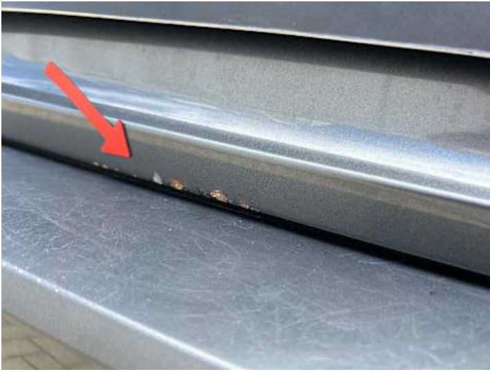
Heckklappe (Kratzer, Rost)
