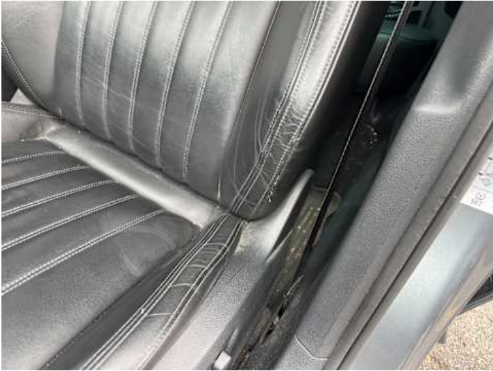
Innenraum (Verschleiß, Riss/Bruch)
