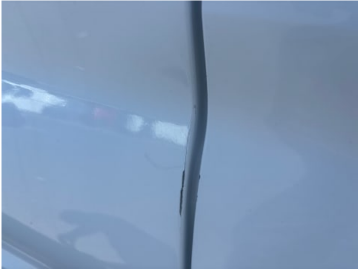
Türe hinten rechts (Kratzer, Lackschaden, Delle)
