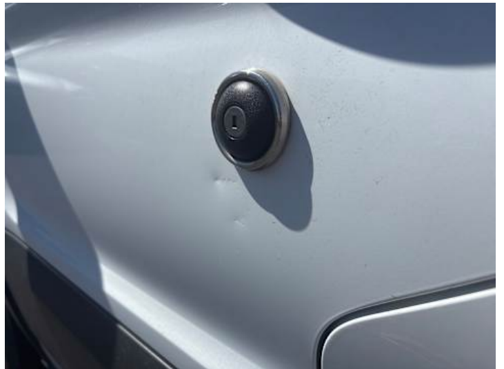
Fahrtür (Kratzer, Delle)
