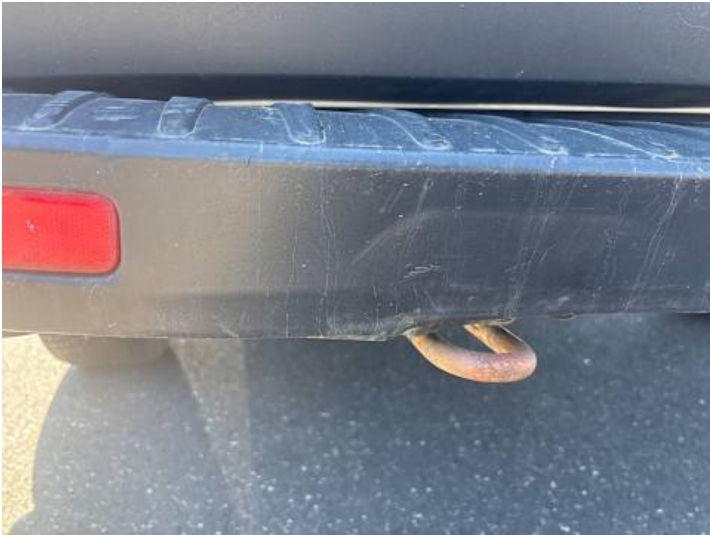
Stoßstange hinten (Kratzer, Riss/Bruch)
