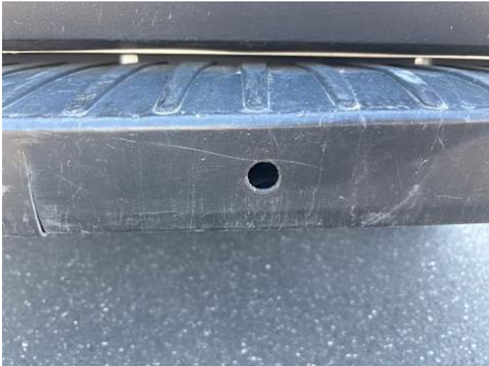
Stoßstange hinten (Kratzer, Riss/Bruch)
