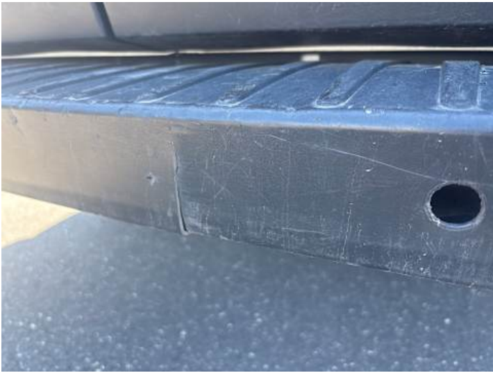
Stoßstange hinten (Kratzer, Riss/Bruch)
