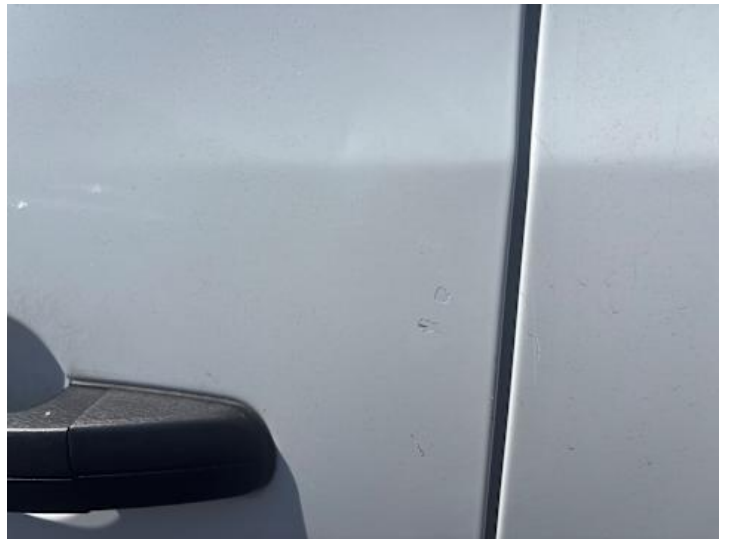
Fahrtür (Kratzer, Delle)
