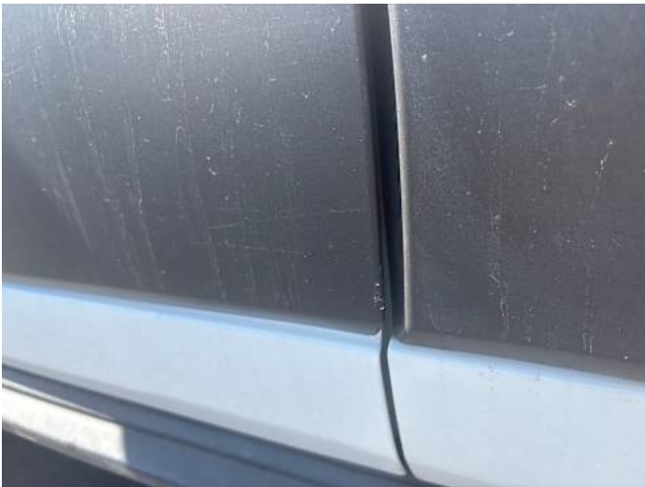
Fahrtür (Kratzer, Delle)
