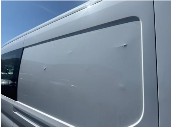
Seitenteil hinten links (Delle, Lackschaden, Kratzer)
