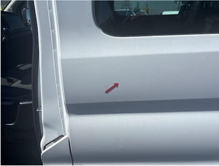
Seitenteil hinten links (Delle, Lackschaden, Kratzer)
