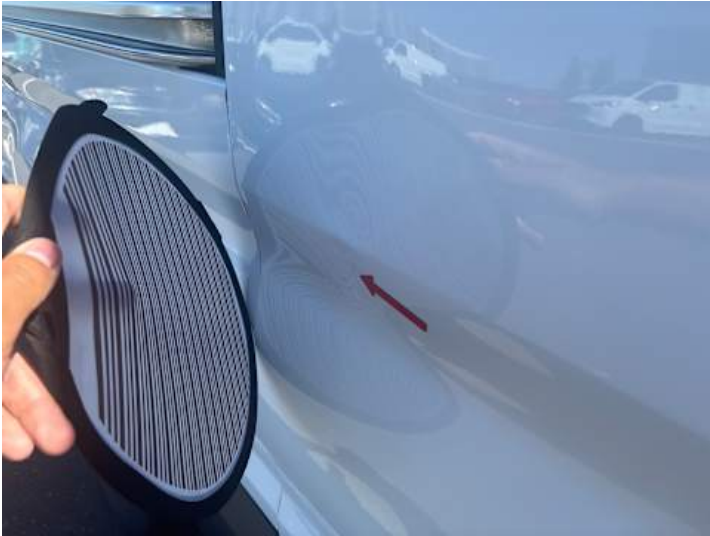
Türe hinten rechts (Kratzer, Lackschaden, Delle)
