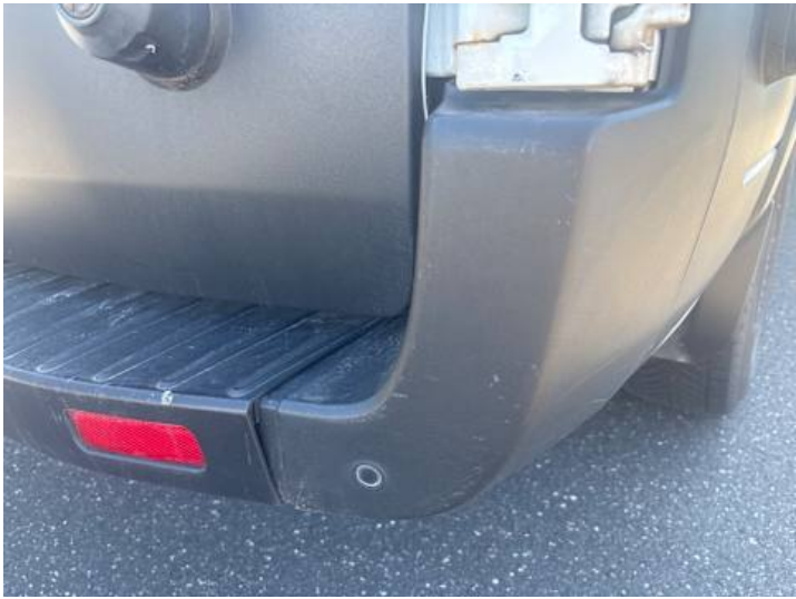
Stoßstange hinten (Kratzer, Riss/Bruch)
