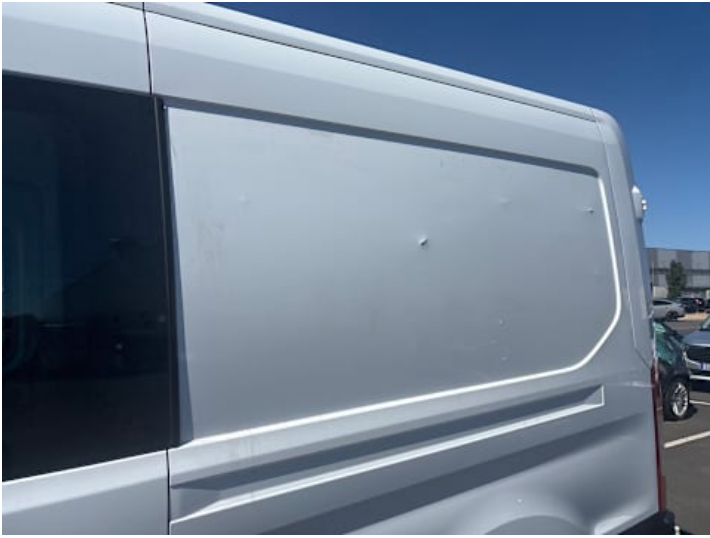
Seitenteil hinten links (Delle, Lackschaden, Kratzer)
