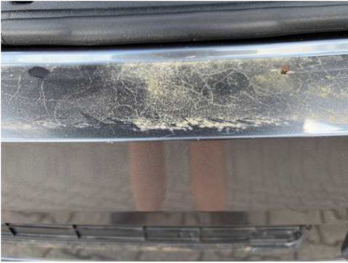
Stoßstange hinten (Kratzer, Lackschaden)
