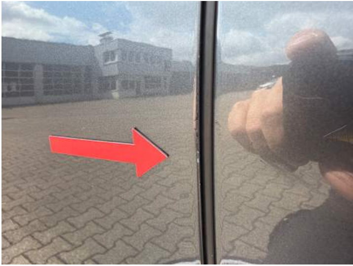
Fahrtür (Kratzer, Lackschaden)
