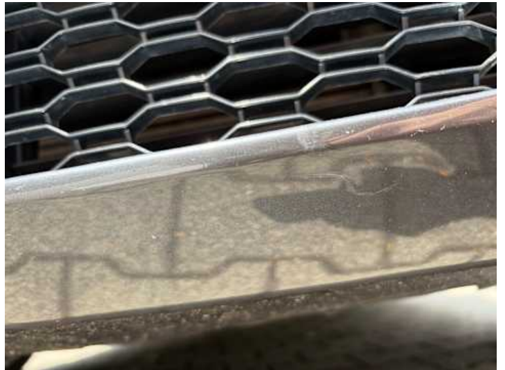
Stoßstange vorne (Lackschaden, Kratzer)
