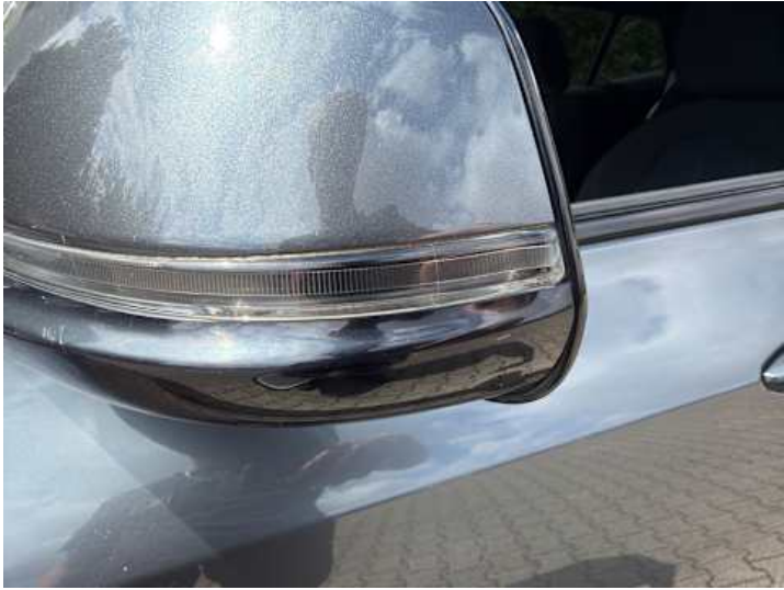
Fahrtür (Kratzer, Lackschaden)
