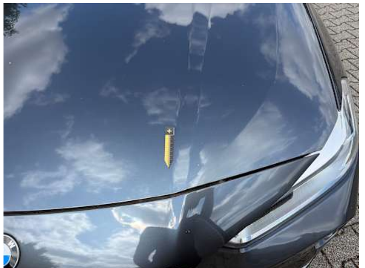
Motorhaube (Steinschlag, Lackschaden)
