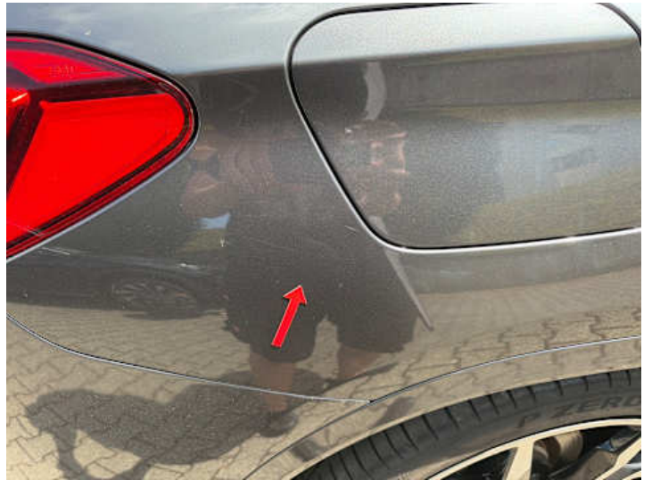
Seitenteil hinten rechts (Kratzer, Lackschaden)
