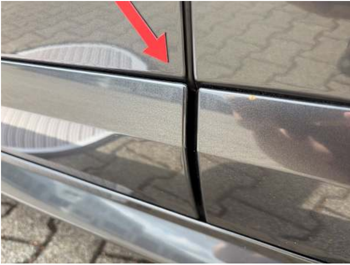
Fahrtür (Kratzer, Lackschaden)
