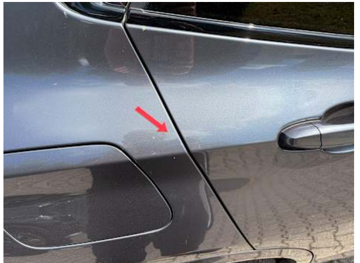
Seitenteil hinten rechts (Kratzer, Lackschaden)
