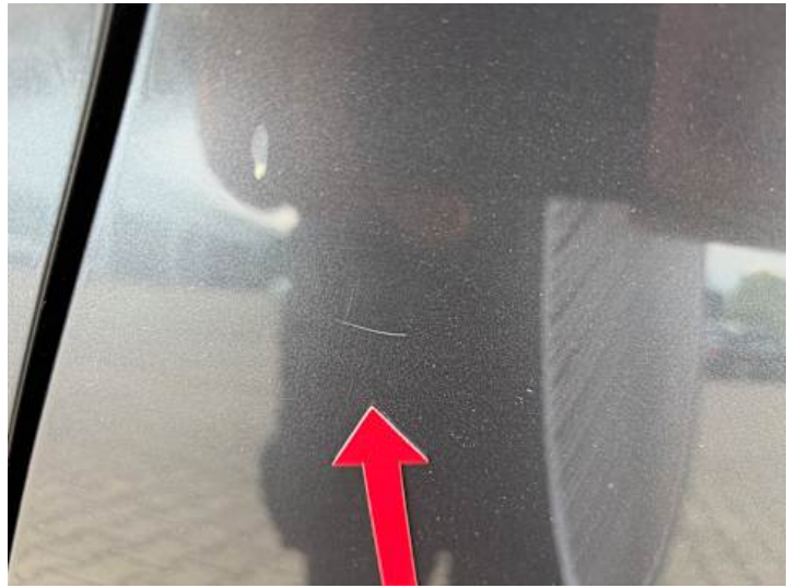
Seitenteil hinten links (Kratzer)
