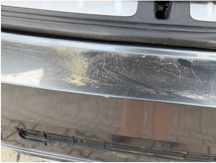
Stoßstange hinten (Kratzer, Lackschaden)
