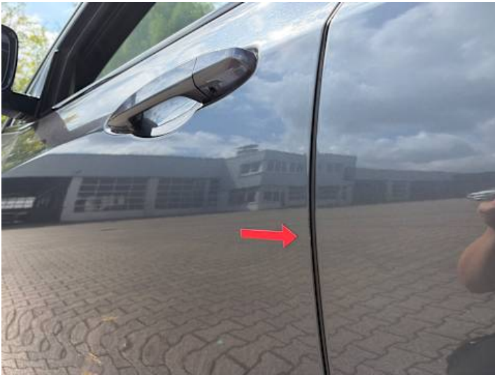
Fahrtür (Kratzer, Lackschaden)
