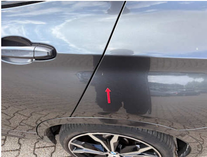
Seitenteil hinten links (Kratzer)
