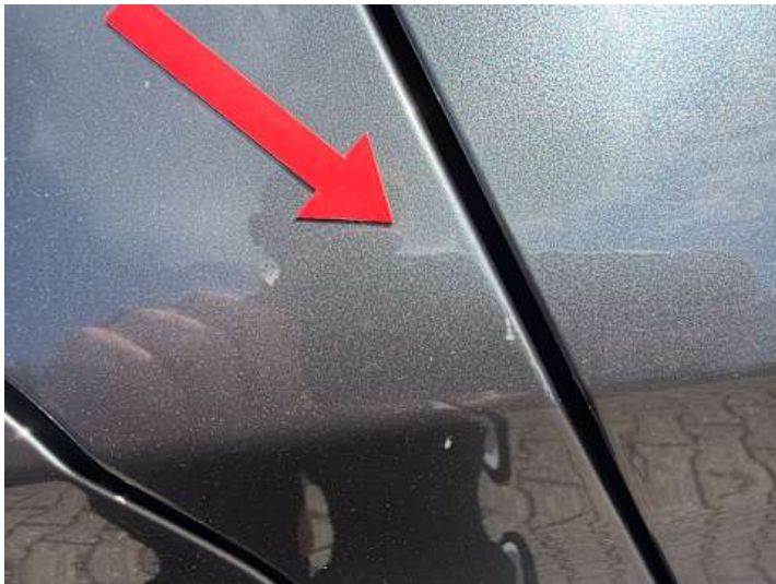
Seitenteil hinten rechts (Kratzer, Lackschaden)
