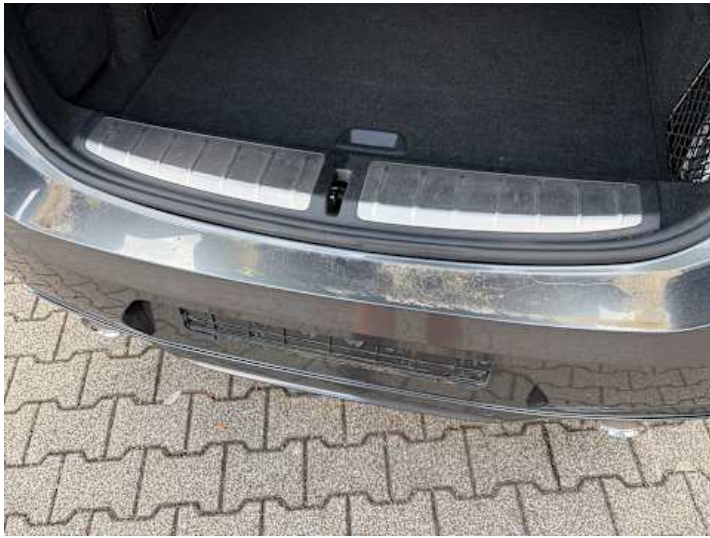
Stoßstange hinten (Kratzer, Lackschaden)
