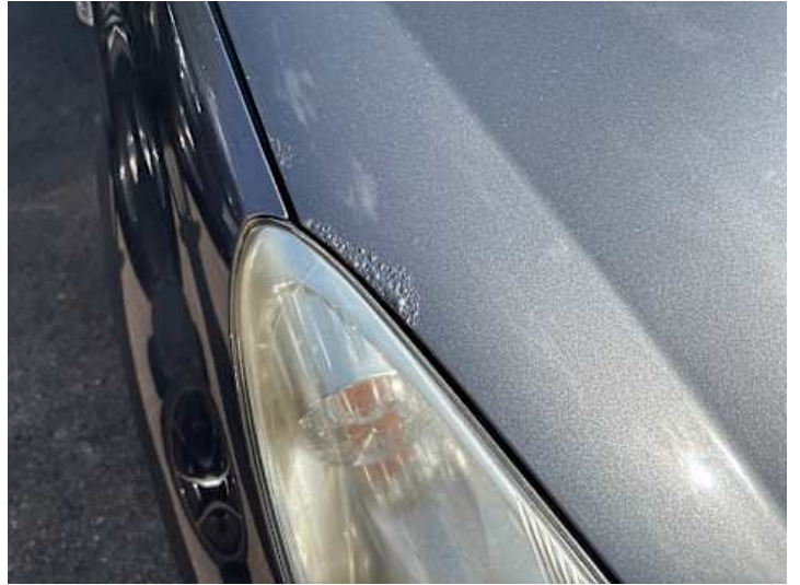
Motorhaube (Lackschaden, Rost)
