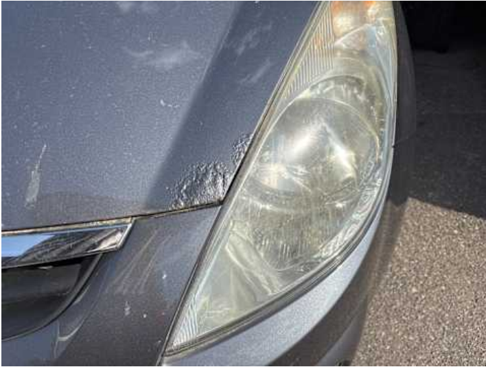
Motorhaube (Lackschaden, Rost)
