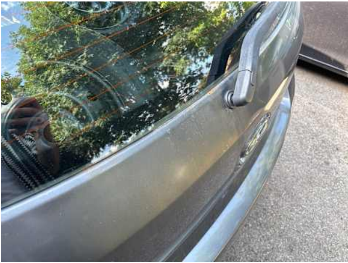
Heckklappe (Rost, Lackschaden, Ausgeblichen/Matt, Unsachgemäß instand gesetzt)
