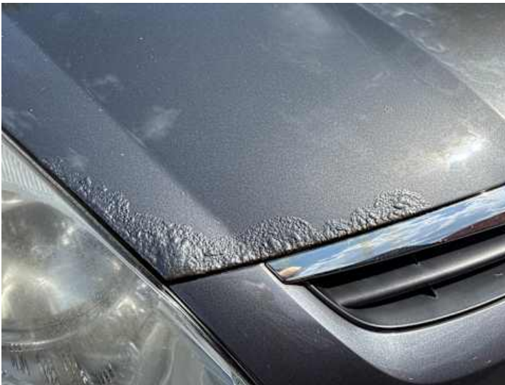
Motorhaube (Lackschaden, Rost)
