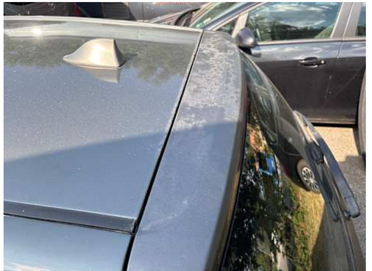
Heckklappe (Rost, Lackschaden, Ausgeblichen/Matt, Unsachgemäß instand gesetzt)
