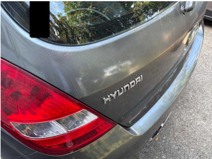
Heckklappe (Rost, Lackschaden, Ausgeblichen/Matt, Unsachgemäß instand gesetzt)
