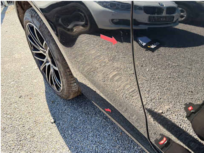
Seitenteil hinten rechts (Kratzer, Delle)
