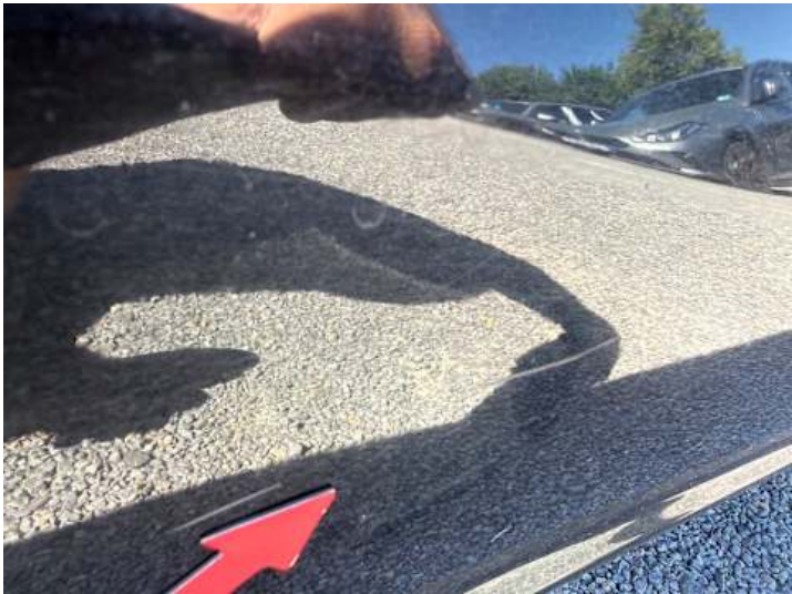
Seitenteil hinten rechts (Kratzer, Delle)
