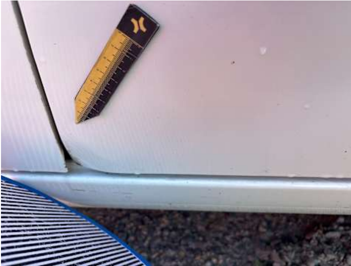
Beifahrertür (Lackschaden, Verformung)
