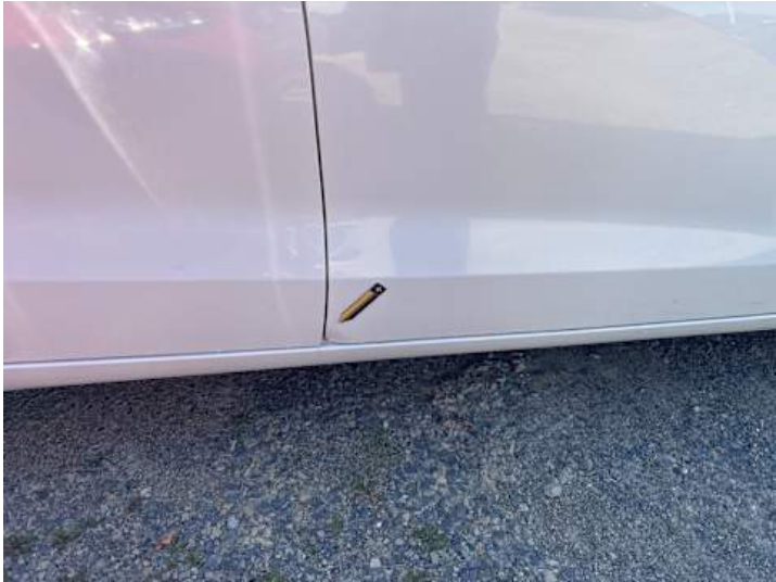
Beifahrertür (Lackschaden, Verformung)
