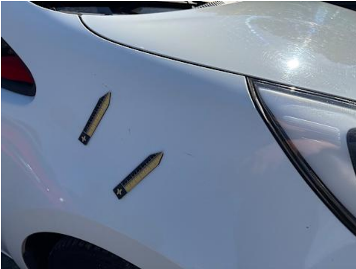
Kotflügel vorne rechts (Lackschaden, Kratzer)
