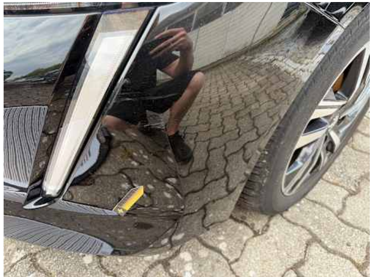
Stoßstange vorne (Kratzer, Lackschaden, Verformung)
