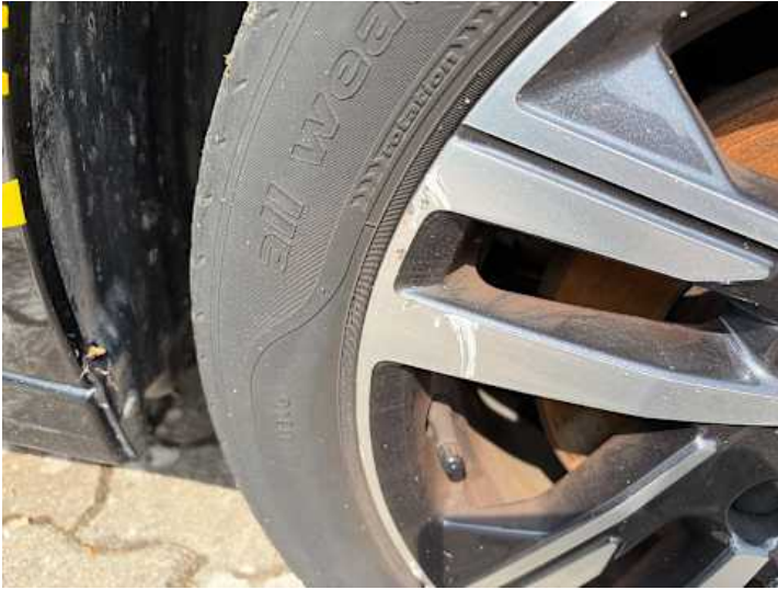
Rad (Kerben, Kratzer, Riss/Bruch)
