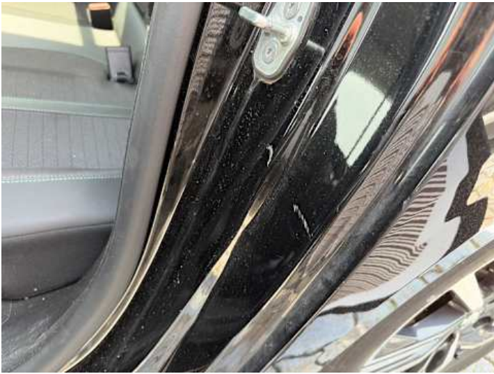
Türe hinten links (Delle, Kratzer, Lackschaden)
