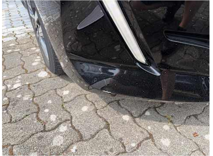
Stoßstange vorne (Kratzer, Lackschaden, Verformung)
