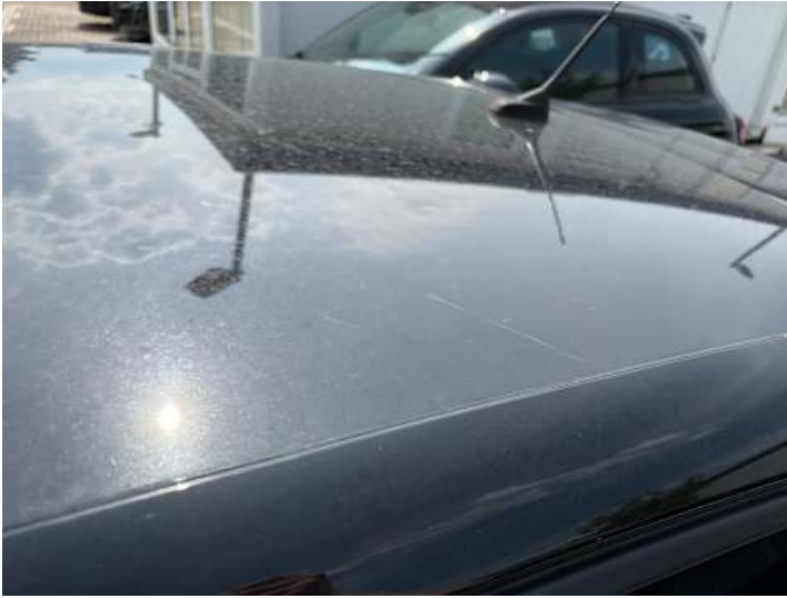
Dach (Lackschaden, Kratzer)
