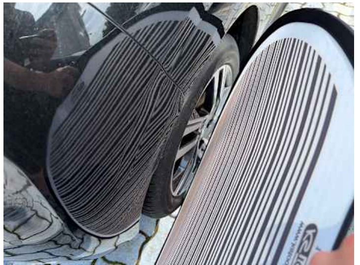
Stoßstange hinten (Verformung)
