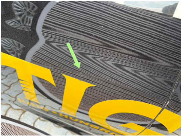
Türe hinten rechts (Delle, Kratzer, Lackschaden)
