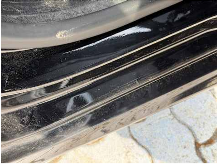
Türe hinten rechts (Delle, Kratzer, Lackschaden)
