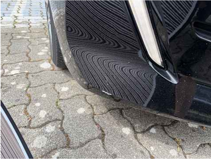
Stoßstange vorne (Kratzer, Lackschaden, Verformung)
