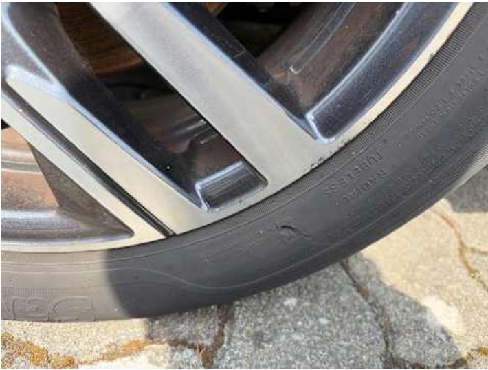
Rad (Kerben, Kratzer, Riss/Bruch)
