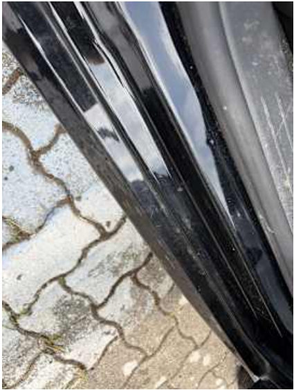
Beifahrtür (Kratzer, Lackschaden)
