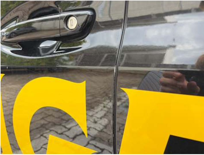
Fahrtür (Lackschaden, Kratzer)
