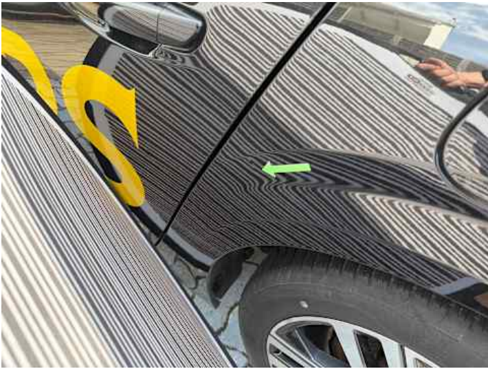
Seitenteil hinten links (Delle, Kratzer, Lackschaden)
