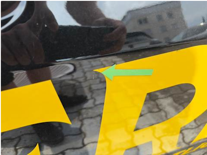
Beifahrertür (Kratzer, Lackschaden)
