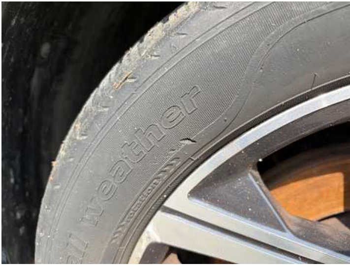
Rad (Kerben, Kratzer, Riss/Bruch)
