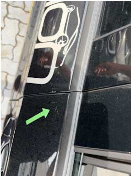
Beifahrertür (Kratzer, Lackschaden)
