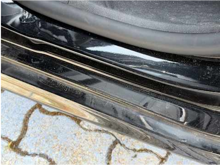
Türe hinten links (Delle, Kratzer, Lackschaden)
