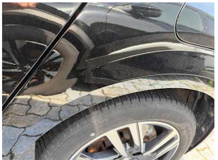
Seitenteil hinten links (Delle, Kratzer, Lackschaden)
