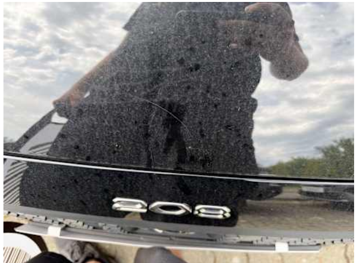
Motorhaube (Kratzer, Lackschaden)
