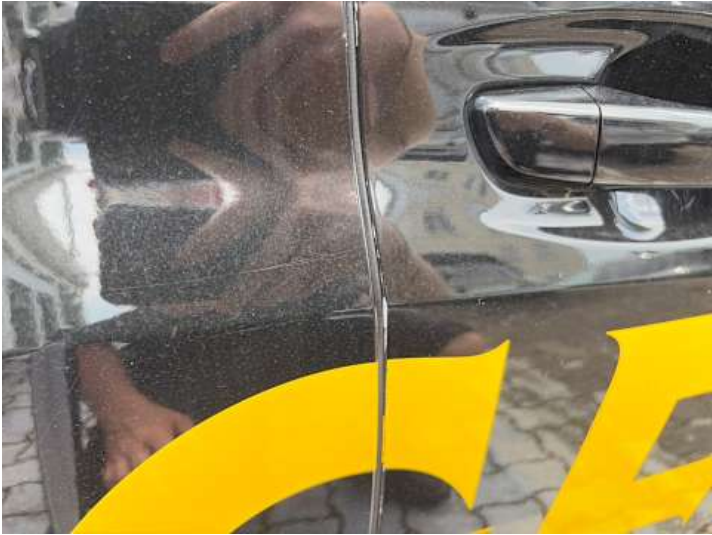
Beifahrertür (Kratzer, Lackschaden)
