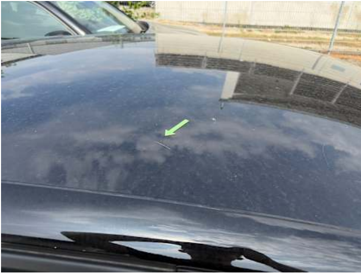
Dach (Lackschaden, Kratzer)
