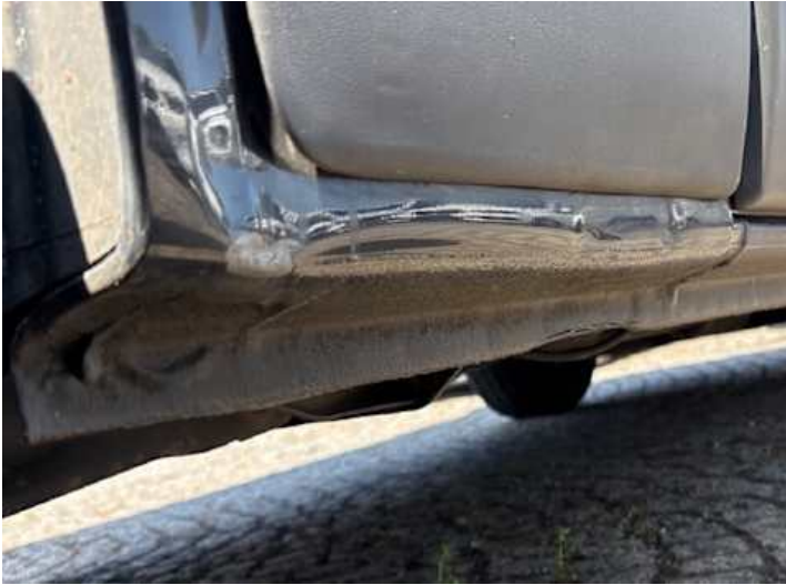
Schweller rechts (Verformung, Lackschaden)
