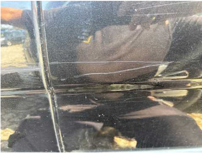
Seitenteil hinten links (Kratzer, Unsachgemäß instand gesetzt)
