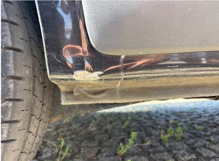
Schweller rechts (Verformung, Lackschaden)
