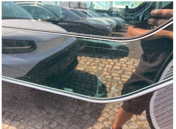
Türe hinten rechts (Anderer Schaden): Scheibe zieht Luft
