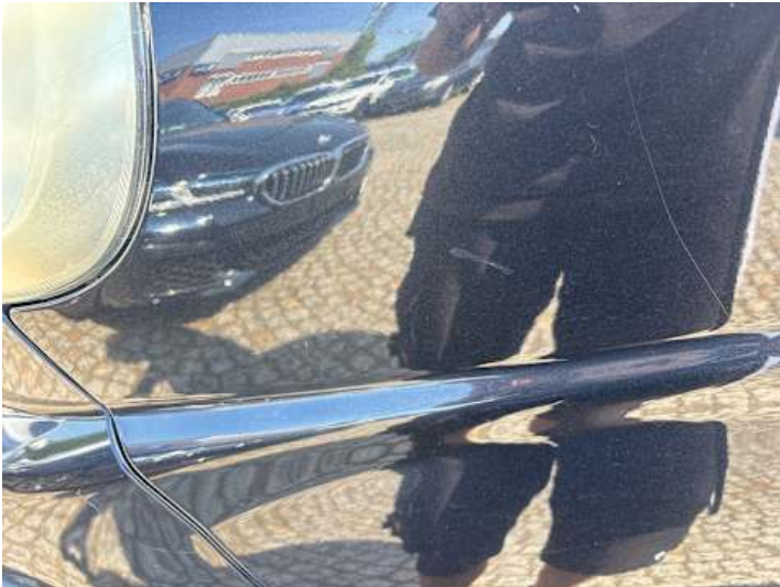
Kotflügel vorne links (Kratzer, Unsachgemäß instand gesetzt)
