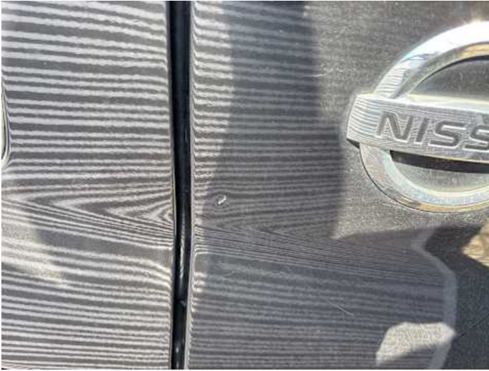
Heckklappe (Kratzer, Delle)
