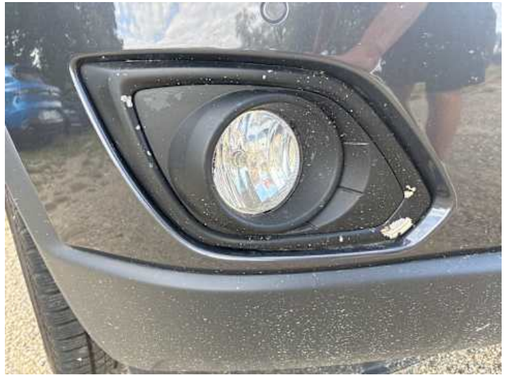
Stoßstange vorne (Spaltmaße ungenau, Lackschaden)
