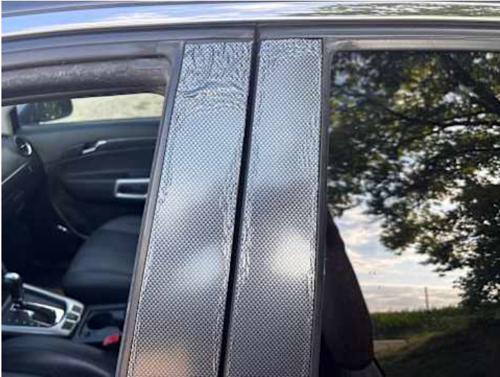
Türe hinten links (Anderer Schaden): Folie an allen Türen beschädigt
