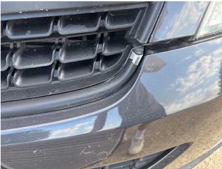
Stoßstange vorne (Spaltmaße ungenau, Lackschaden)
