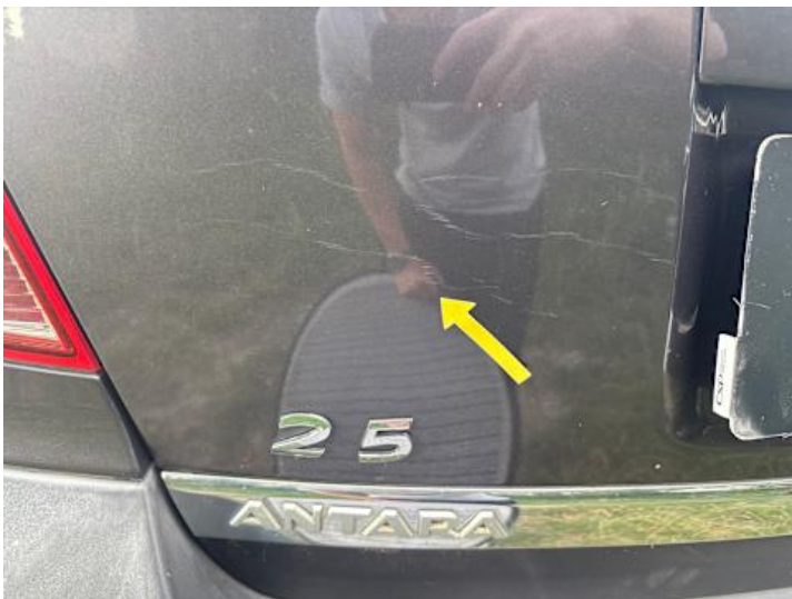
Heckklappe (Kratzer, Lackschaden, Ausgeblichen/Matt)
