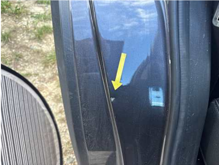
Türe hinten rechts (Delle, Kratzer)
