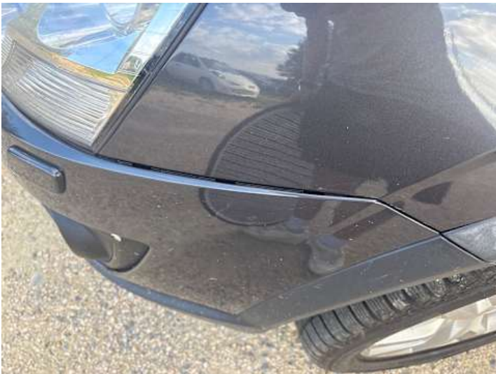
Stoßstange vorne (Spaltmaße ungenau, Lackschaden)
