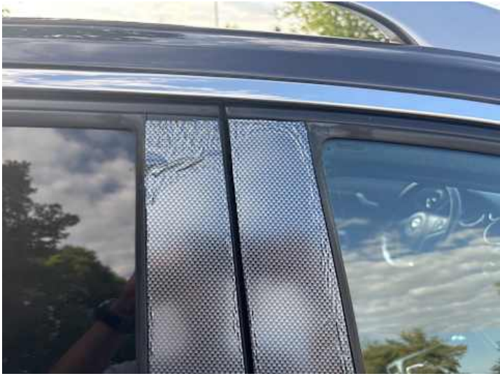
Fahrtür (Anderer Schaden): Folie an allen Türen beschädigt
