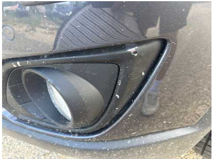
Stoßstange vorne (Spaltmaße ungenau, Lackschaden)
