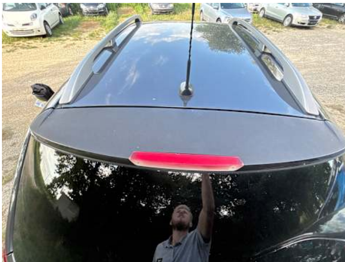
Heckklappe (Kratzer, Lackschaden, Ausgeblichen/Matt)
