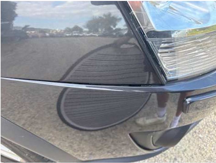
Stoßstange vorne (Spaltmaße ungenau, Lackschaden)
