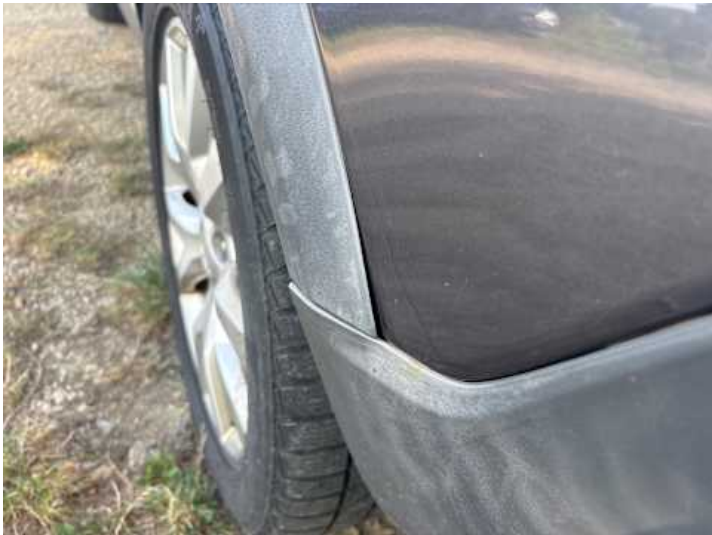
Seitenteil hinten links (Spaltmaße ungenau)
