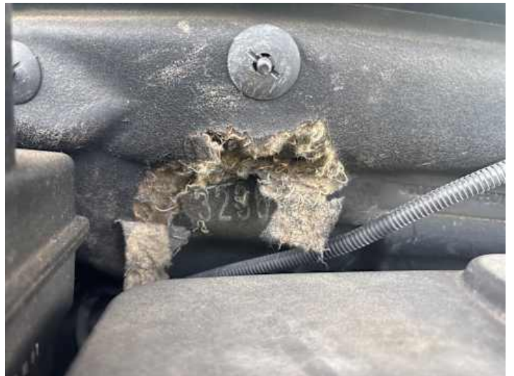
Motorhaube (Anderer Schaden): Dämmatte angefressen
