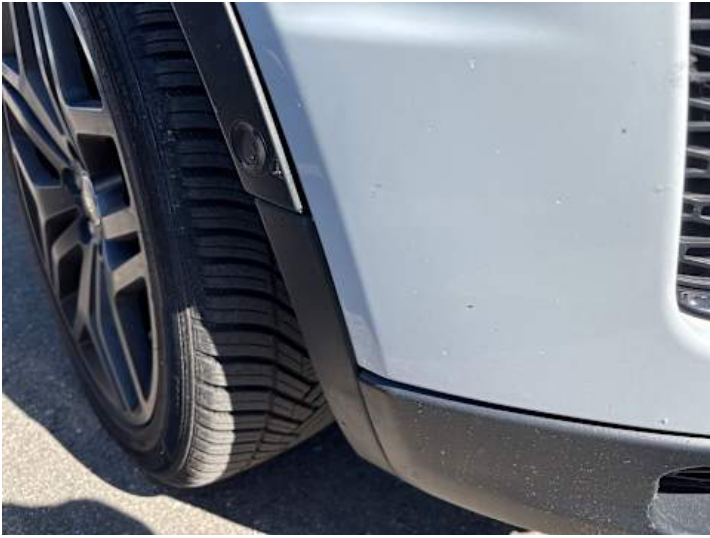
Kotflügel vorne rechts (Spaltmaße ungenau)
