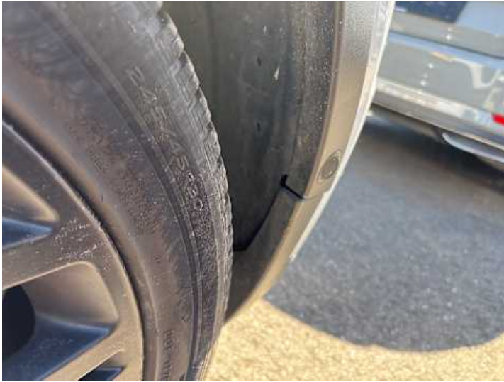
Kotflügel vorne rechts (Spaltmaße ungenau)
