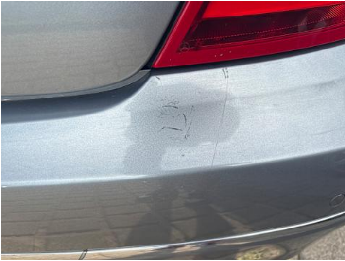
Stoßstange hinten (Kratzer, Lackschaden, Verformung, Spaltmaße ungenau)
