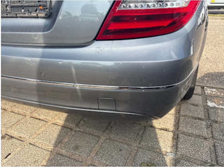
Stoßstange hinten (Kratzer, Lackschaden, Verformung, Spaltmaße ungenau)
