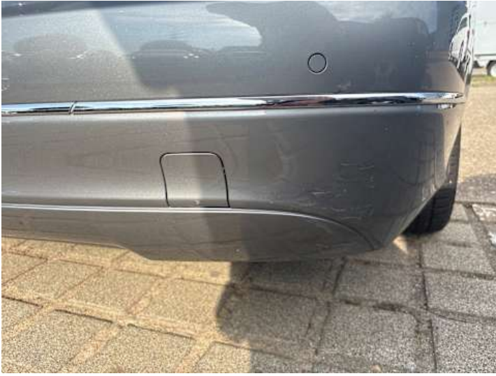
Stoßstange hinten (Kratzer, Lackschaden, Verformung, Spaltmaße ungenau)
