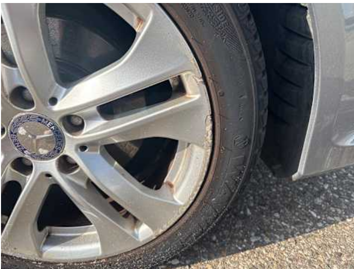
Rad (Kerben, Kratzer, Riss/Bruch)
