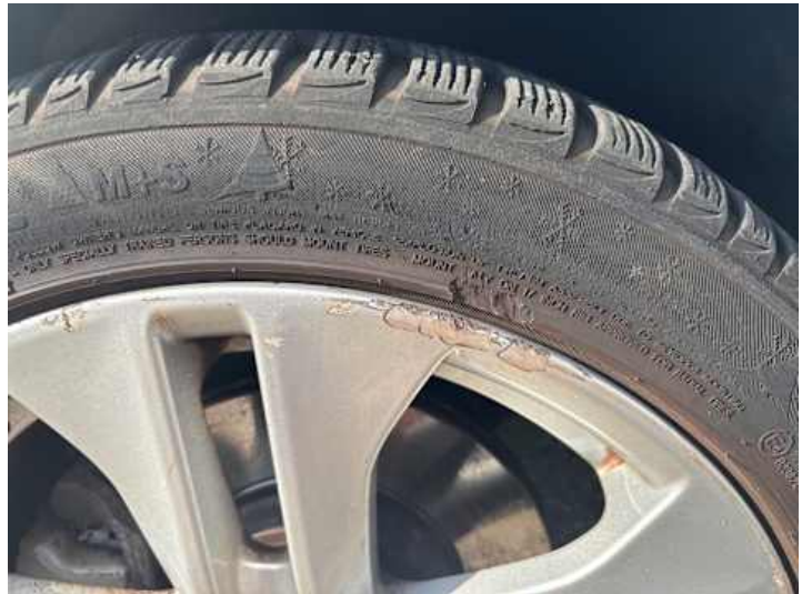
Rad (Kerben, Kratzer, Riss/Bruch)
