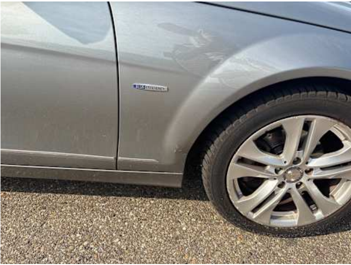
Kotflügel vorne rechts (Verformung, Lackschaden)
