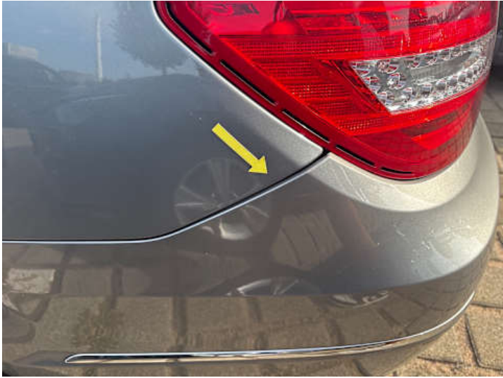
Stoßstange hinten (Kratzer, Lackschaden, Verformung, Spaltmaße ungenau)
