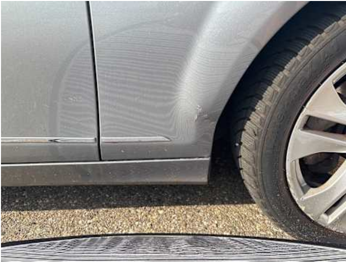
Kotflügel vorne rechts (Verformung, Lackschaden)
