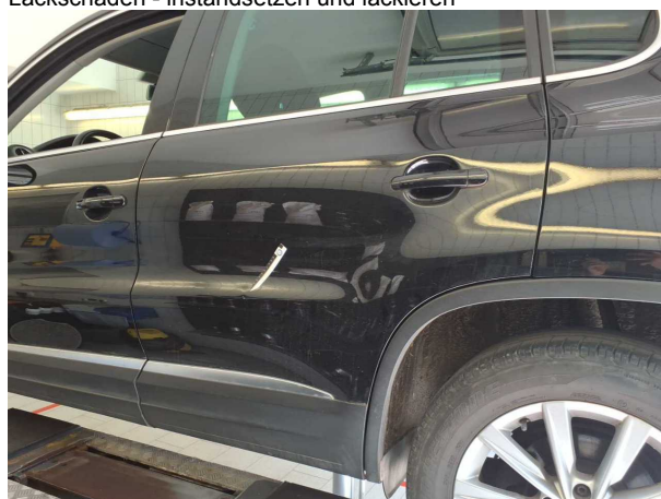
Beschädigung 11: Tür hinten links: Tür - Delle / Lackschade... instandsetzen und lackieren
