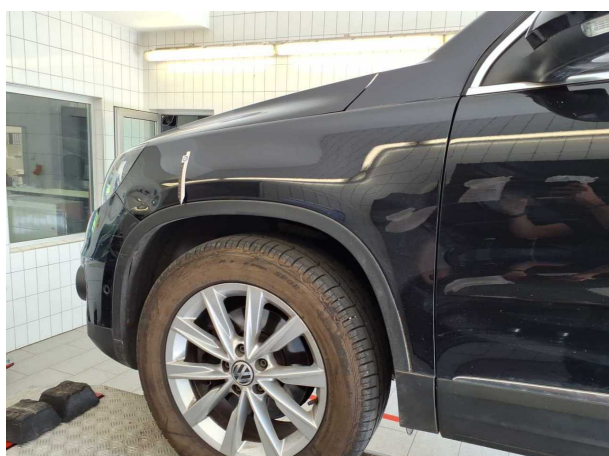
Beschädigung 2: Kotflügel links: Radlauf - beschädigt - erneuern
