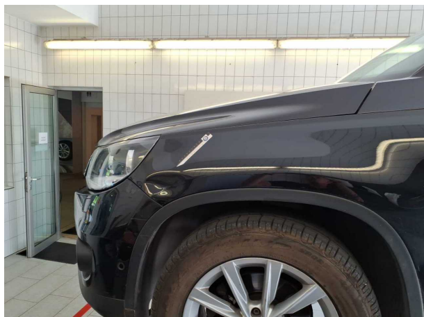
Beschädigung 12: Kotflügel links: Kotflügel links - verformt - erneuern
