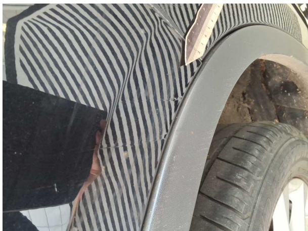
Beschädigung 4: Stossfänger hinten: Stossfänger hinten rechts - Kratzer - Smart Repair
