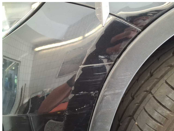
Beschädigung 6: Stossfänger vorn: Stossfänger vorn links - verkratzt / verschürft - instandsetzen und lackieren
