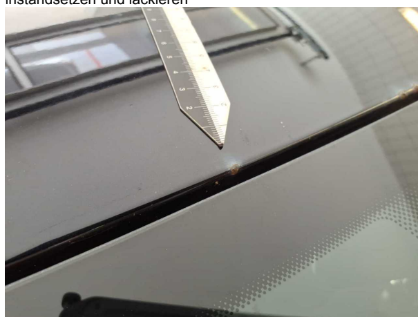
Beschädigung 13: Fahrzeugdach: Dach - Korrosion - instandsetzen und lackieren
