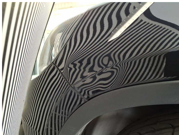
Beschädigung 12: Kotflügel links: Kotflügel links - verformt - erneuern
