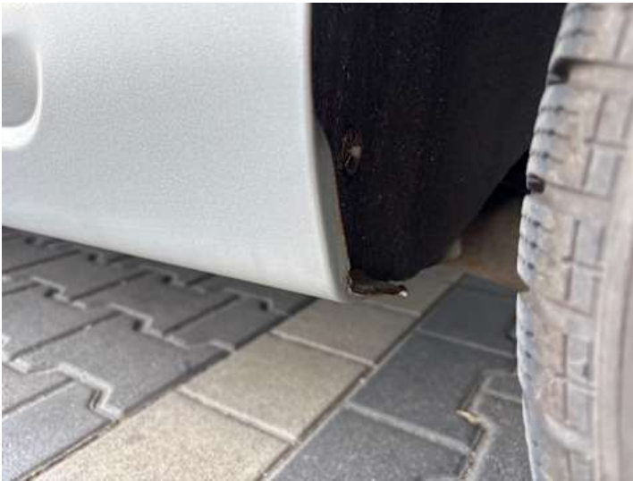
Schweller links (Rost)
