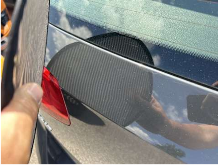
Heckklappe (Delle, Verformung)
