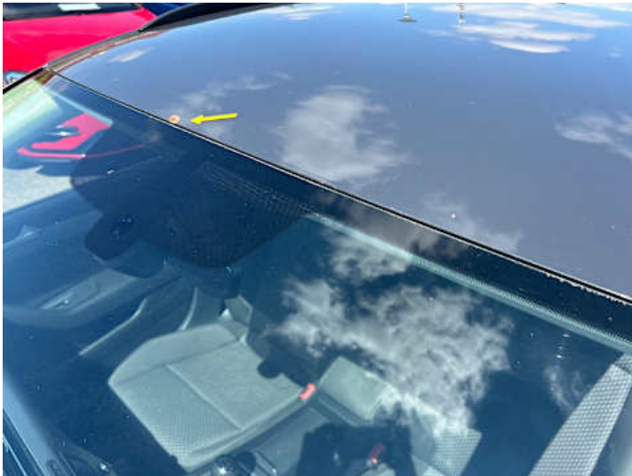
Dach (Rost, Steinschlag)
