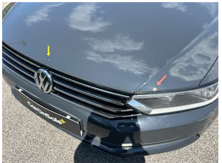
Motorhaube (Rost, Steinschlag)
