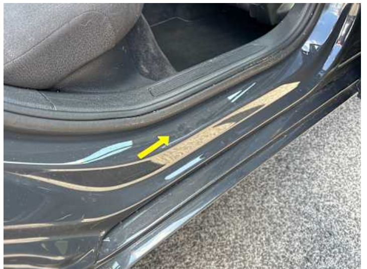
Schweller rechts (Delle)
