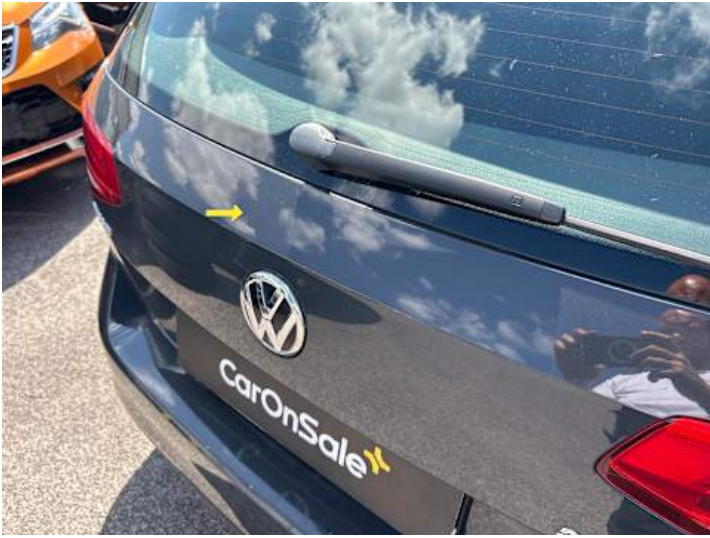
Heckklappe (Delle, Verformung)
