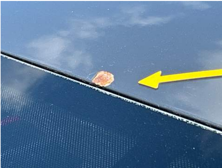
Dach (Rost, Steinschlag)
