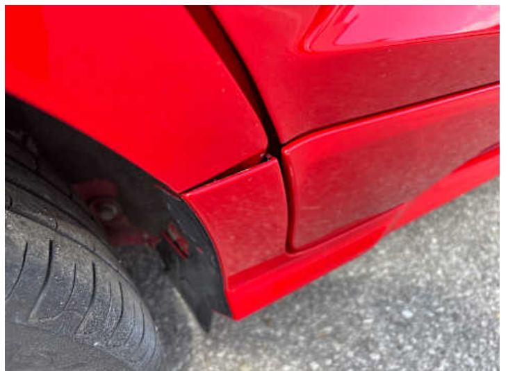
Schweller rechts (Spaltmaße ungenau)
