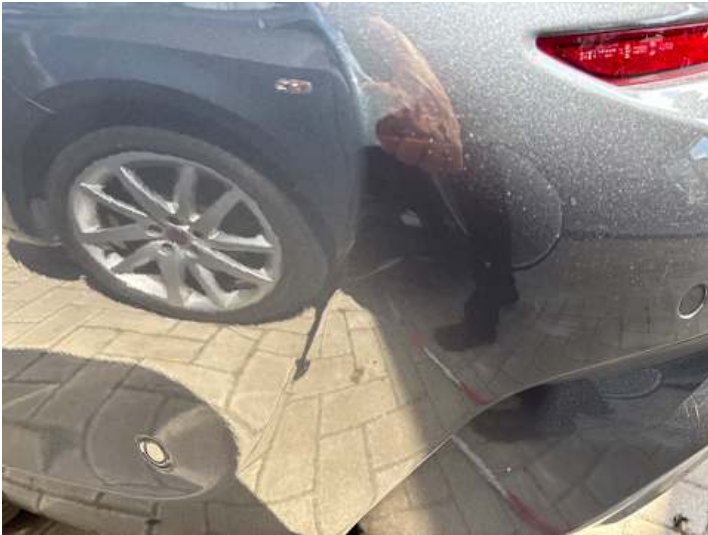
Stoßstange hinten (Kratzer, Anderer Schaden): Farbunterschied
