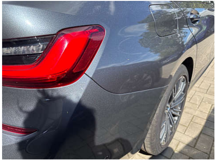
Stoßstange hinten (Kratzer, Anderer Schaden): Farbunterschied
