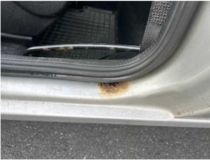
Schweller links (Rost)
