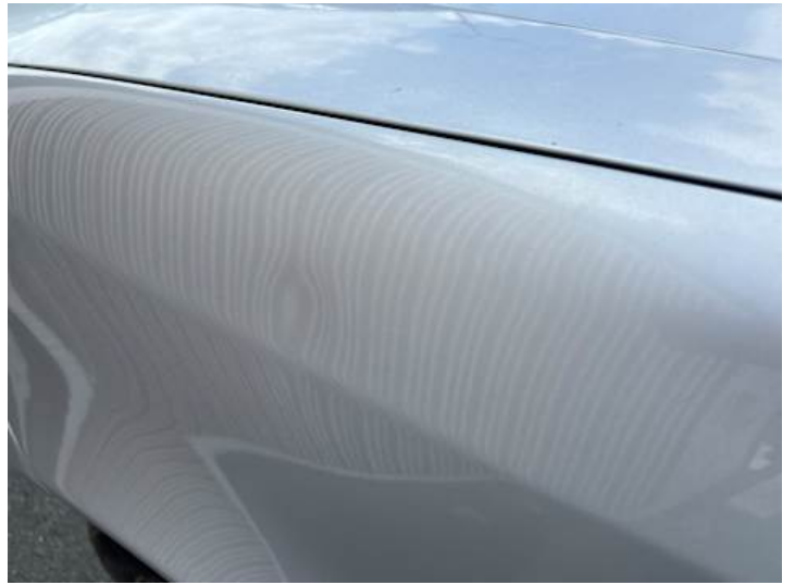
Kotflügel vorne links (Verformung)
