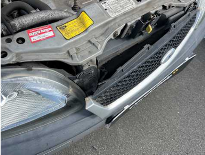
Stoßstange vorne (Riss/Bruch)
