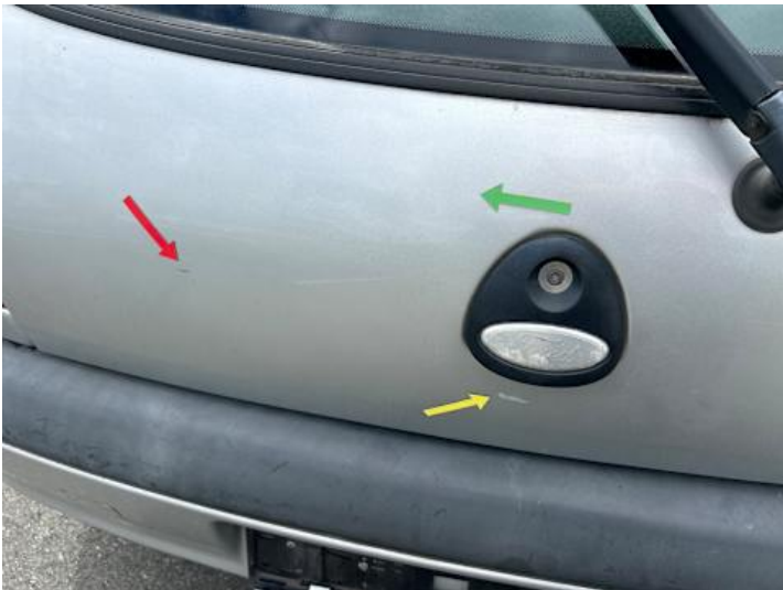
Heckklappe (Kratzer, Delle)
