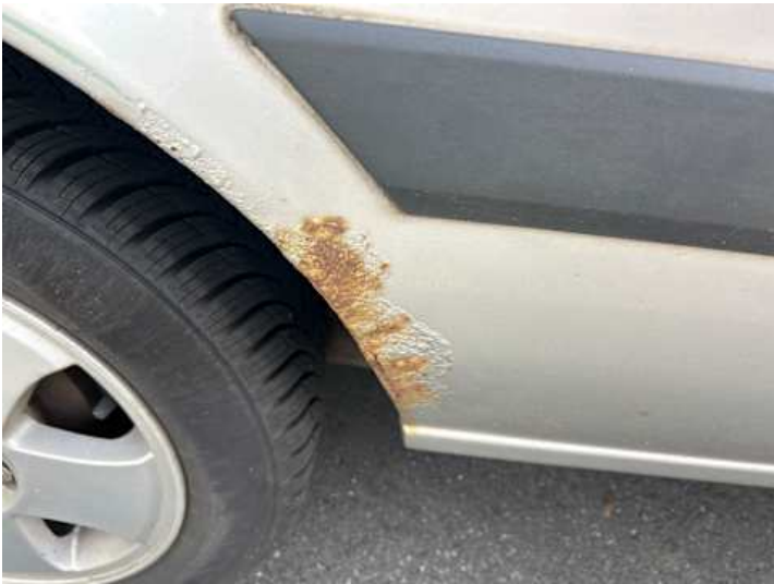
Seitenteil hinten rechts (Rost)
