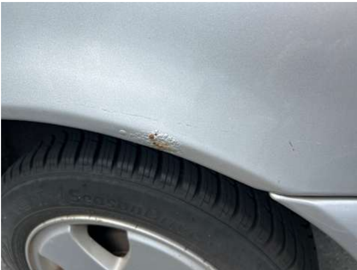
Seitenteil hinten links (Rost)
