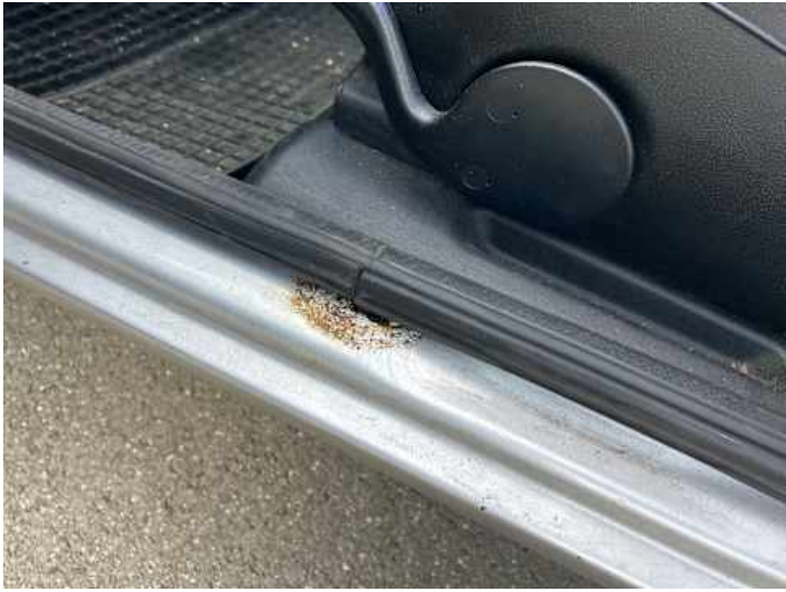
Schweller links (Rost)
