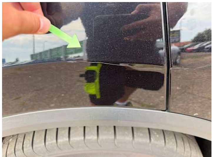
Seitenteil hinten rechts (Kratzer)
