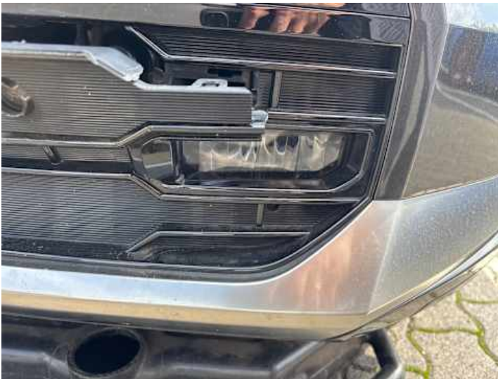
Scheinwerfer (links) (Riss/Bruch)
