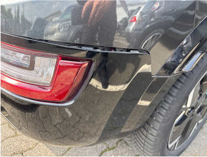
Stoßstange hinten (Riss/Bruch, Spaltmaße ungenau)
