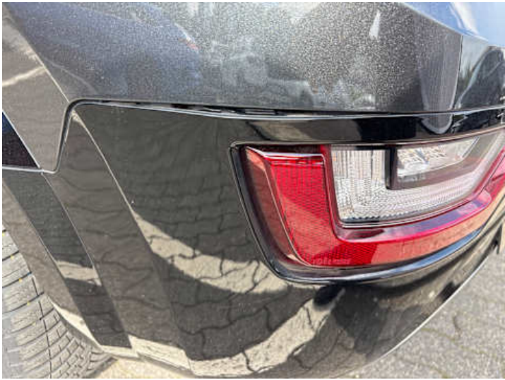
Stoßstange hinten (Riss/Bruch, Spaltmaße ungenau)
