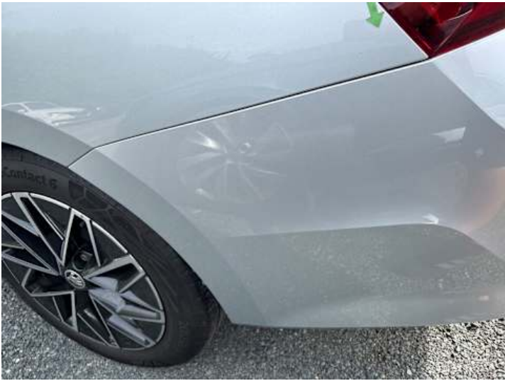
Stoßstange hinten (Spaltmaße ungenau)
