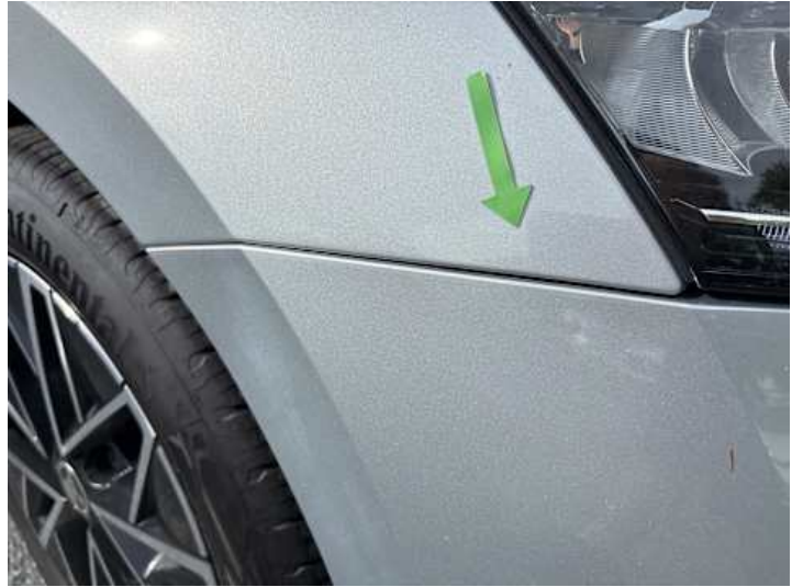
Stoßstange vorne (Spaltmaße ungenau)
