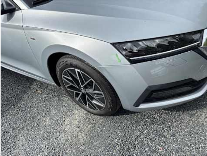
Stoßstange vorne (Spaltmaße ungenau)
