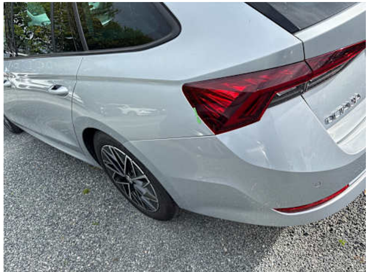
Stoßstange hinten (Spaltmaße ungenau)
