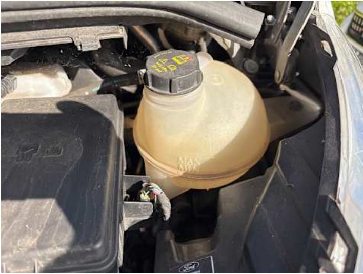
Motorhaube (Anderer Schaden): Kühlmittelstand zu gering,
