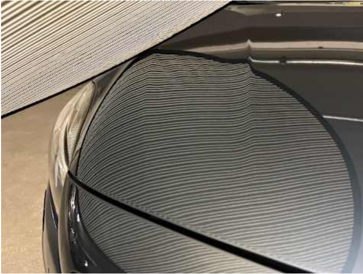
Motorhaube (Lackschaden, Unsachgemäß instand gesetzt)
