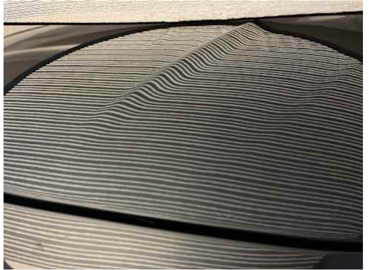
Motorhaube (Lackschaden, Unsachgemäß instand gesetzt)
