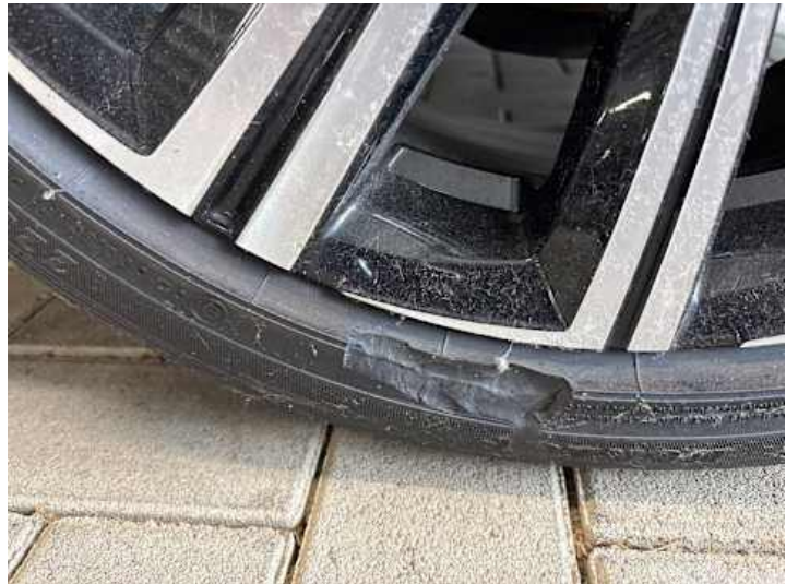
Rad (Anderer Schaden): Karkasse beschädigt
