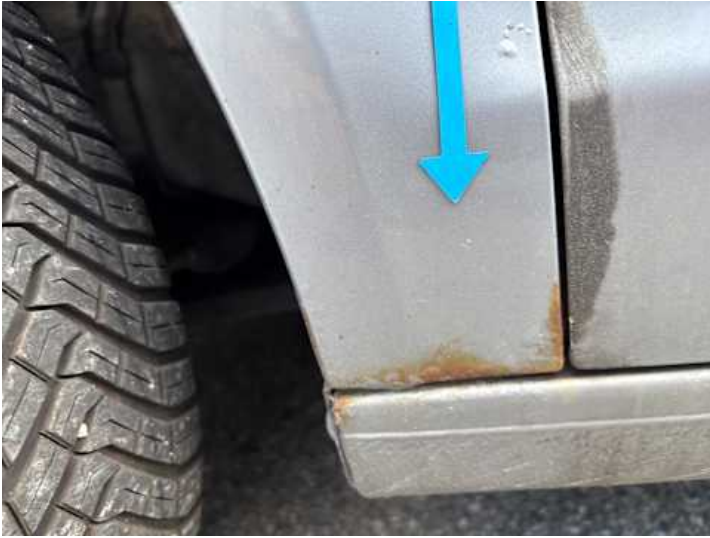
Kotflügel vorne links (Rost)
