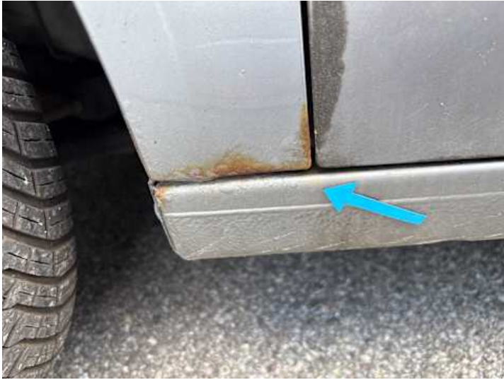
Schweller links (Rost)
