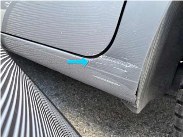
Schweller links (Delle, Kratzer)
