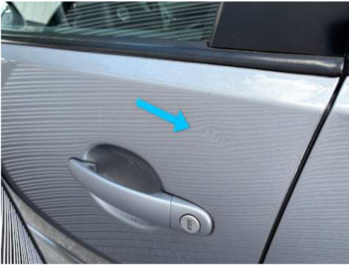
Fahrtür (Delle, Kratzer)
