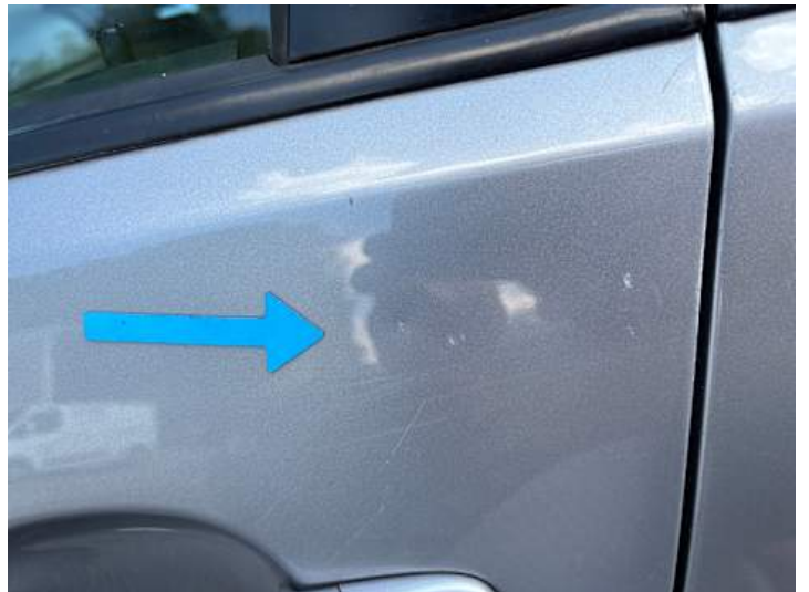
Fahrtür (Delle, Kratzer)
