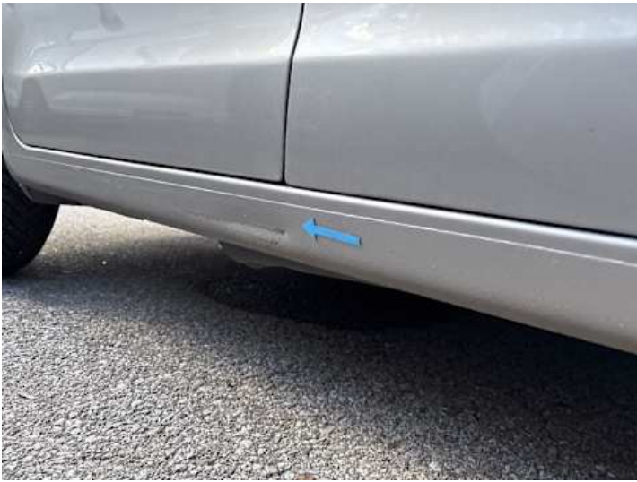
Schweller rechts (Kratzer, Delle)
