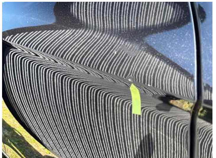
Türe hinten rechts (Kratzer, Delle)
