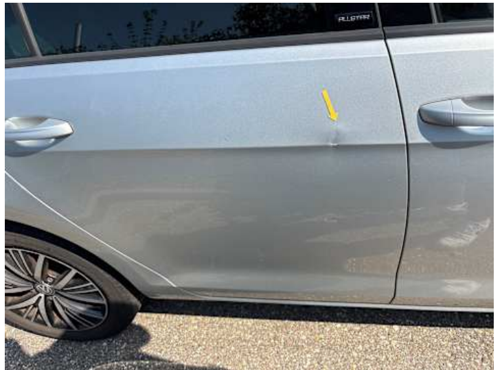
Türe hinten rechts (Verformung, Lackschaden)
