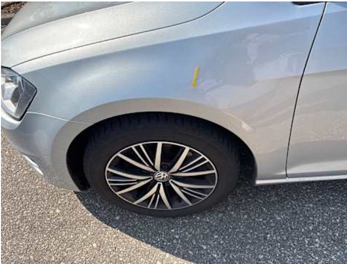
Kotflügel vorne links (Kratzer, Lackschaden)
