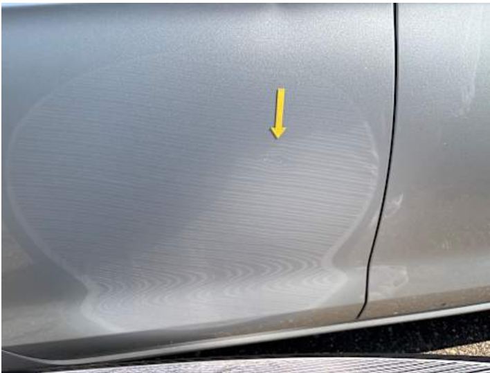
Türe hinten rechts (Verformung, Lackschaden)
