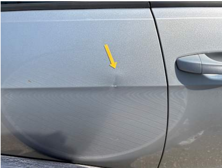
Türe hinten rechts (Verformung, Lackschaden)
