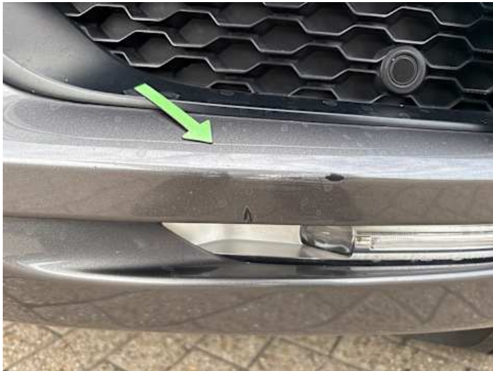
Stoßstange vorne (Lackschaden)
