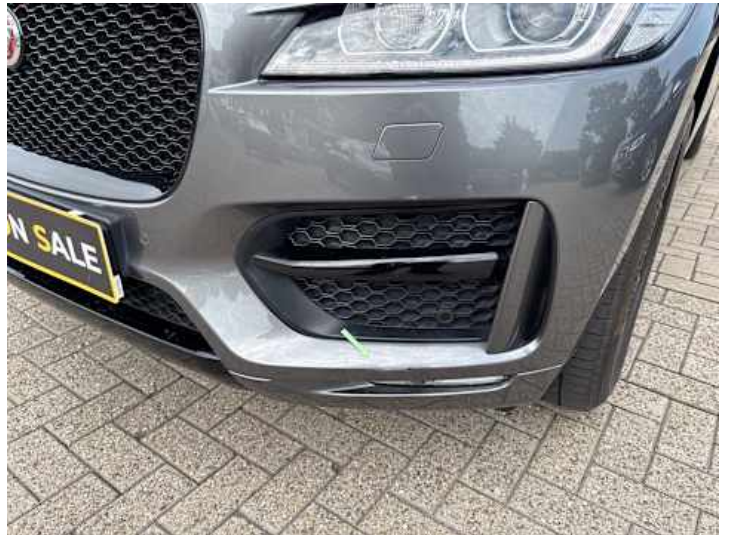
Stoßstange vorne (Lackschaden)
