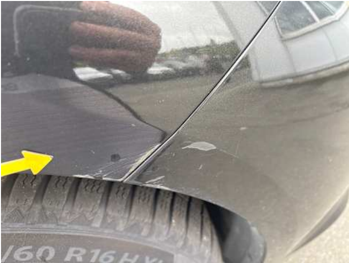
Kotflügel vorne rechts (Kratzer, Rost)
