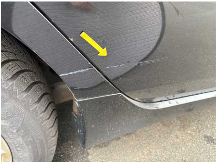
Türe hinten rechts (Kratzer)
