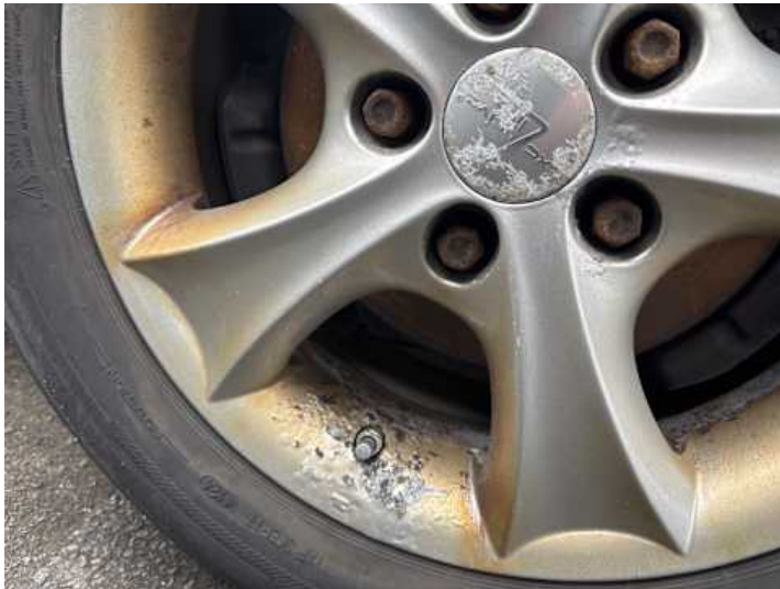
Rad (Kratzer, Kerben, Rost)
