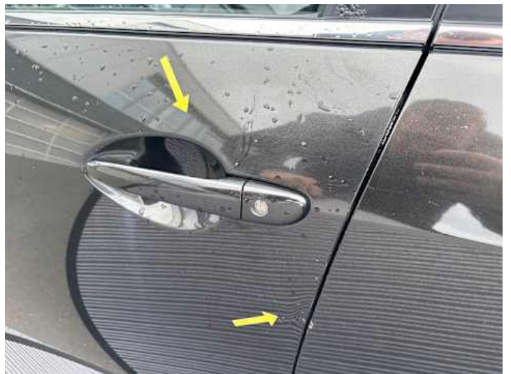
Fahrtür (Kratzer, Delle)
