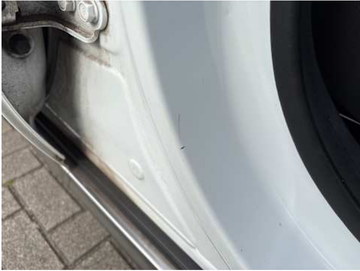
Schweller rechts (Kratzer, Delle)
