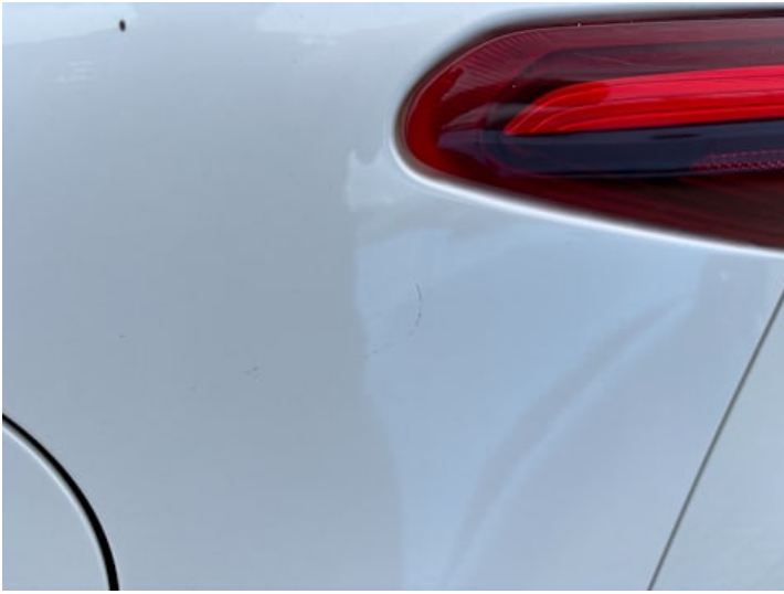
Seitenteil hinten links (Kratzer)
