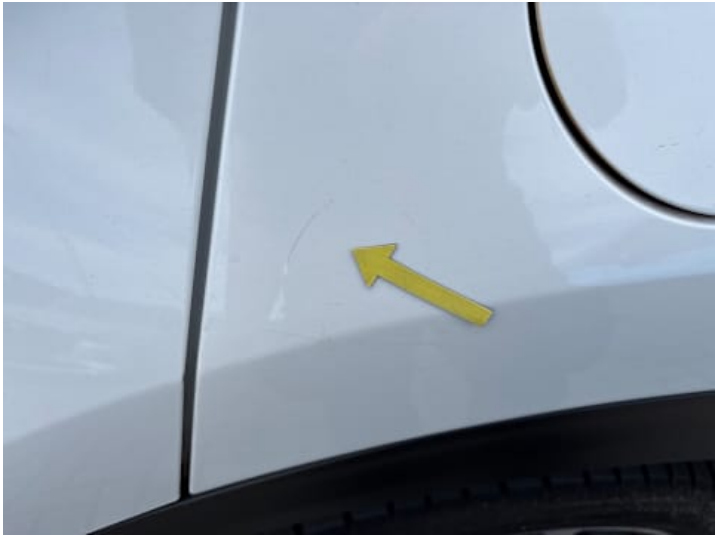
Seitenteil hinten links (Kratzer)
