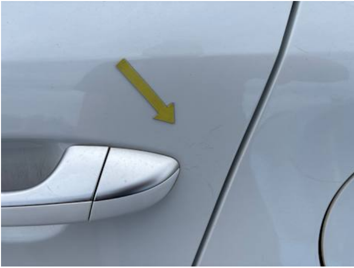
Türe hinten links (Lackschaden, Kratzer)
