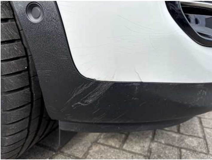
Stoßstange vorne (Riss/Bruch, Lackschaden, Kratzer, Spaltmaße ungenau)
