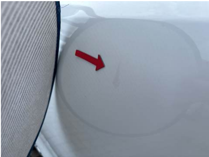
Fahrtür (Delle, Lackschaden)
