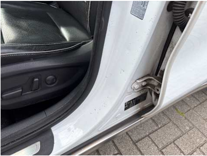
Schweller links (Lackschaden, Delle, Kratzer)
