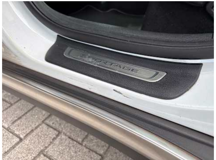
Schweller links (Lackschaden, Delle, Kratzer)
