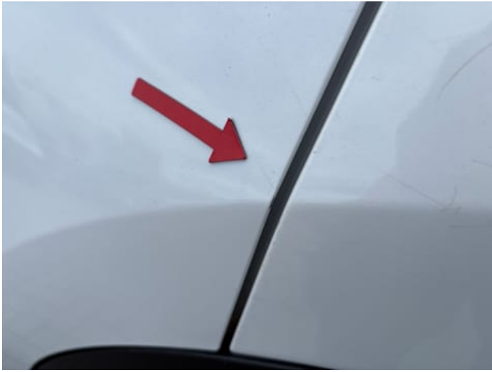
Türe hinten links (Lackschaden, Kratzer)
