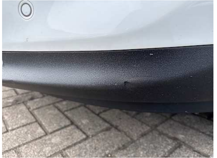
Stoßstange vorne (Kratzer, Lackschaden)
