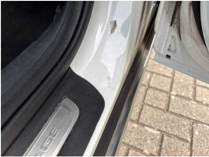
Schweller rechts (Kratzer, Delle)
