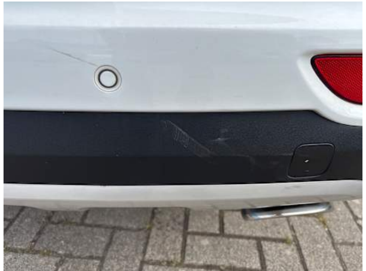
Stoßstange hinten (Kratzer, Lackschaden, Riss/Bruch)
