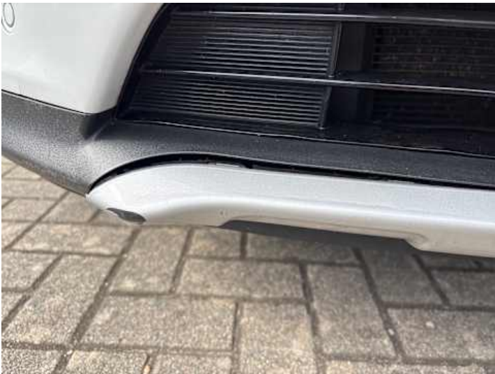
Stoßstange vorne (Kratzer, Lackschaden, Riss/Bruch)
