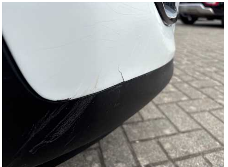
Stoßstange vorne (Riss/Bruch, Lackschaden, Kratzer, Spaltmaße ungenau)
