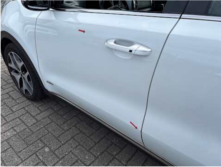
Fahrtür (Delle, Lackschaden)
