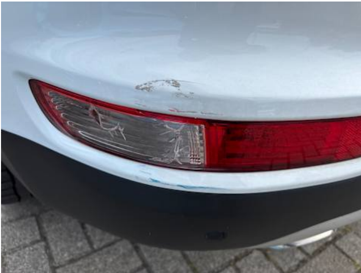
Stoßstange hinten (Kratzer, Lackschaden, Riss/Bruch)
