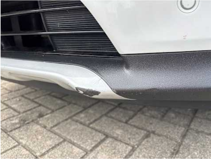
Stoßstange vorne (Kratzer, Lackschaden)
