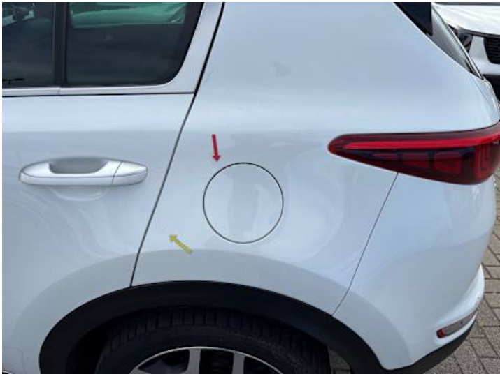
Seitenteil hinten links (Kratzer)
