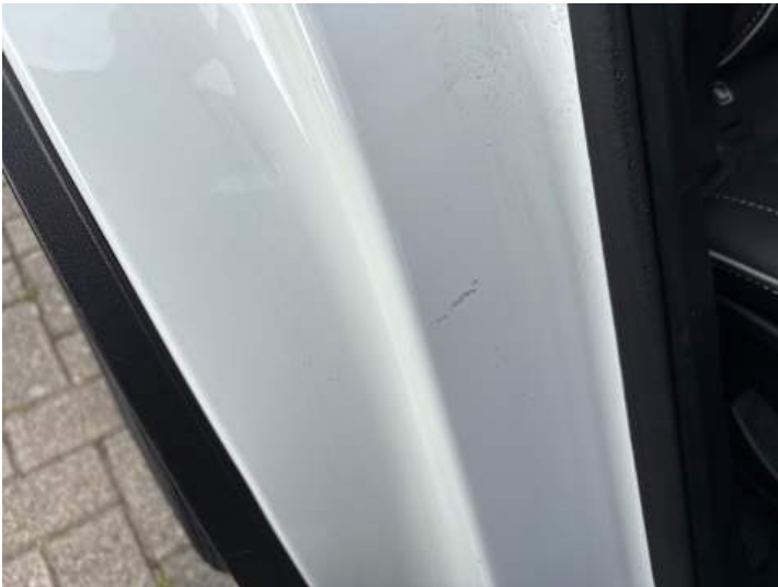
Seitenteil hinten rechts (Lackschaden)
