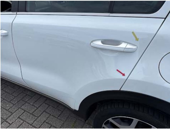
Türe hinten links (Lackschaden, Kratzer)
