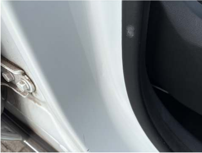
Schweller rechts (Kratzer, Delle)
