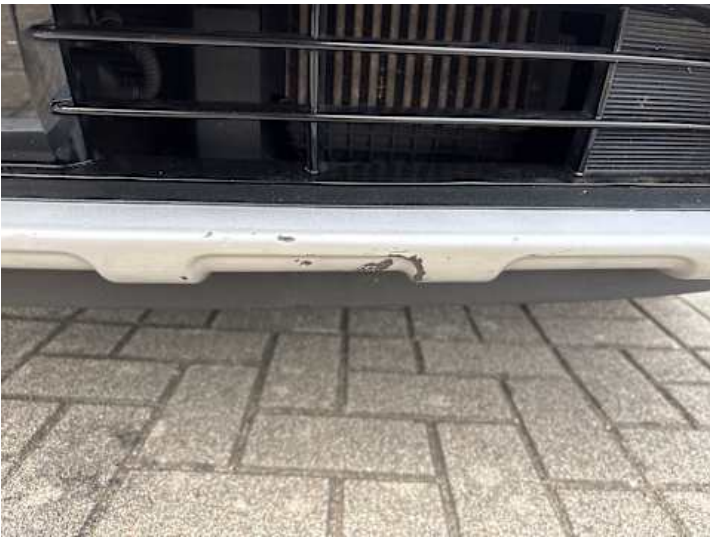
Stoßstange vorne (Kratzer, Lackschaden, Riss/Bruch)
