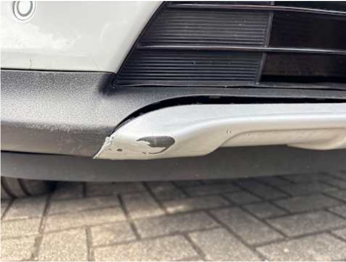
Stoßstange vorne (Kratzer, Lackschaden, Riss/Bruch)
