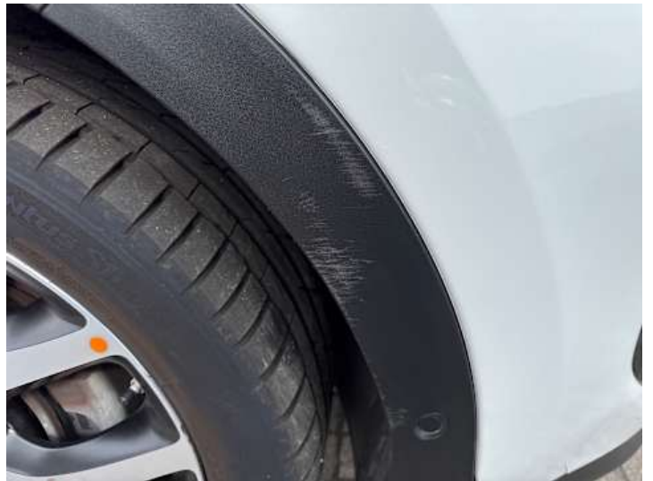
Stoßstange vorne (Riss/Bruch, Lackschaden, Kratzer, Spaltmaße ungenau)
