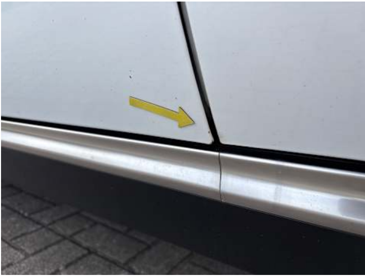
Fahrtür (Delle, Lackschaden)
