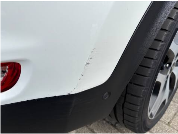
Stoßstange hinten (Lackschaden, Kratzer)
