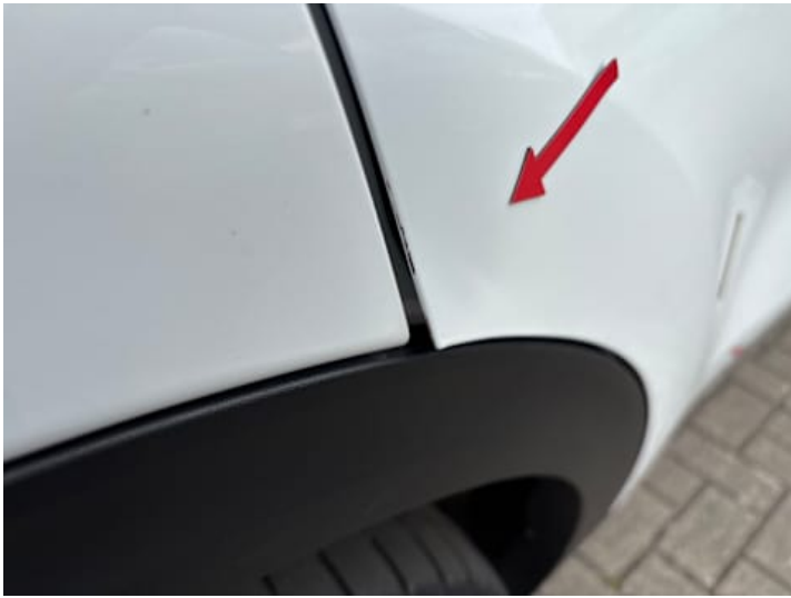
Türe hinten rechts (Kratzer, Verformung, Lackschaden)
