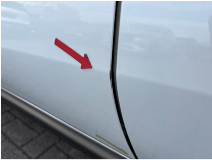
Fahrtür (Delle, Lackschaden)
