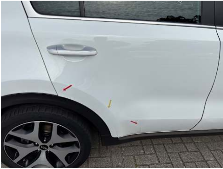
Türe hinten rechts (Kratzer, Verformung, Lackschaden)
