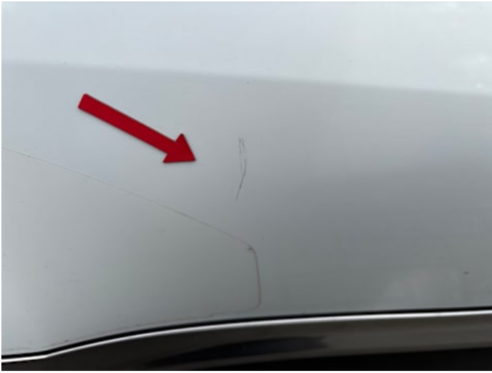
Türe hinten rechts (Kratzer, Verformung, Lackschaden)
