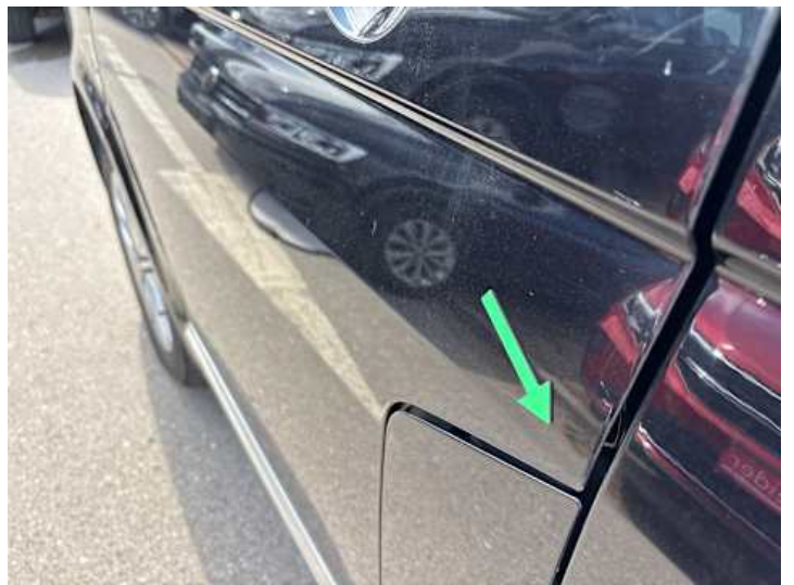
Fahrertür (Kratzer, Lackschaden, Unsachgemäß instand gesetzt)
