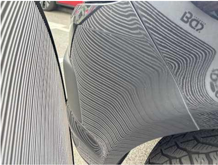
Stoßstange vorne (Lackschaden, Unsachgemäß instand gesetzt)
