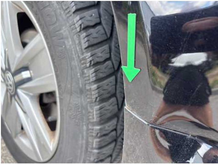
Seitenteil hinten links (Rost)
