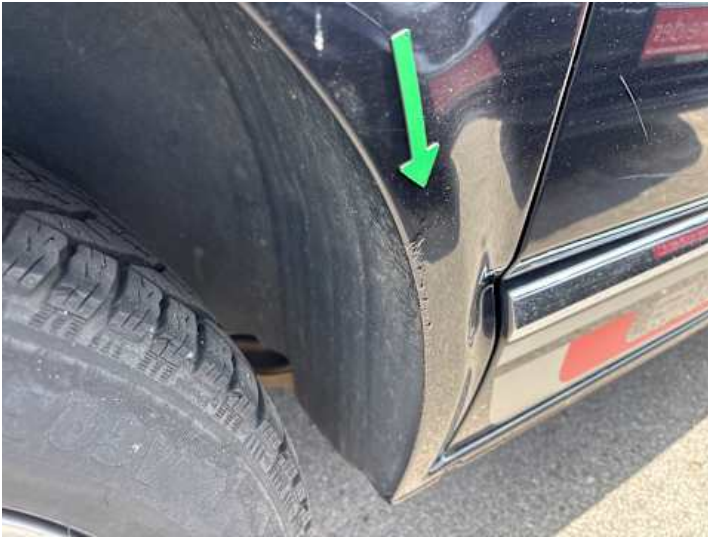
Seitenteil hinten rechts (Rost)
