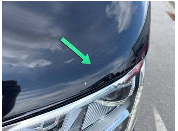
Motorhaube (Steinschlag, Kratzer, Lackschaden, Unsachgemäß instand gesetzt)
