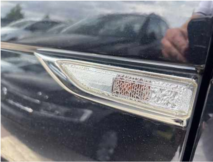
Kotflügel vorne links (Riss/Bruch)
