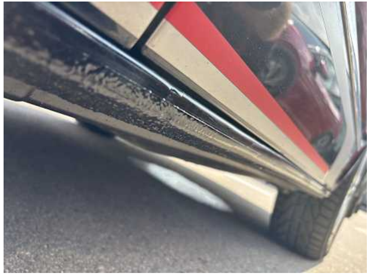
Schweller rechts (Verformung, Unsachgemäß instand gesetzt, Lackschaden)
