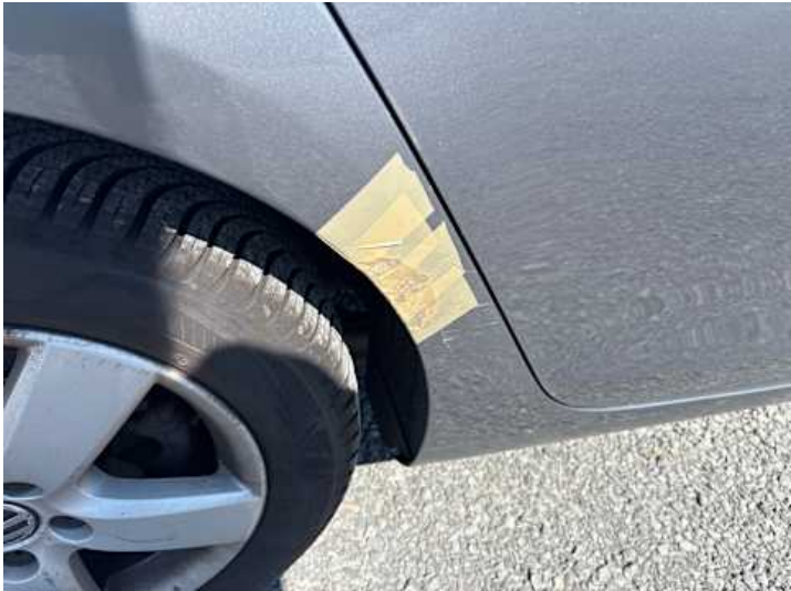
Seitenteil hinten rechts (Rost, Unsachgemäß instand gesetzt, Kratzer)
