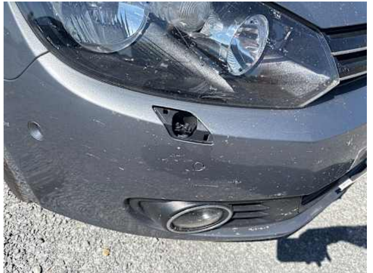
Stoßstange vorne (Anderer Schaden): Abdeckung fehlt
