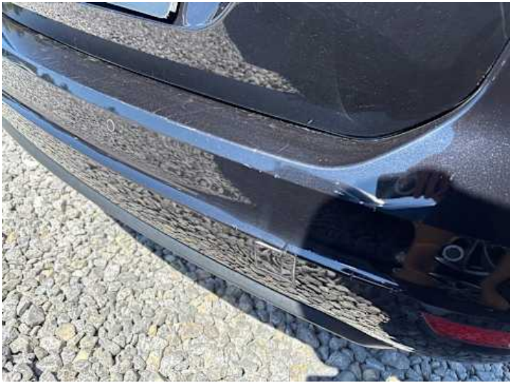
Stoßstange hinten (Kratzer, Delle)
