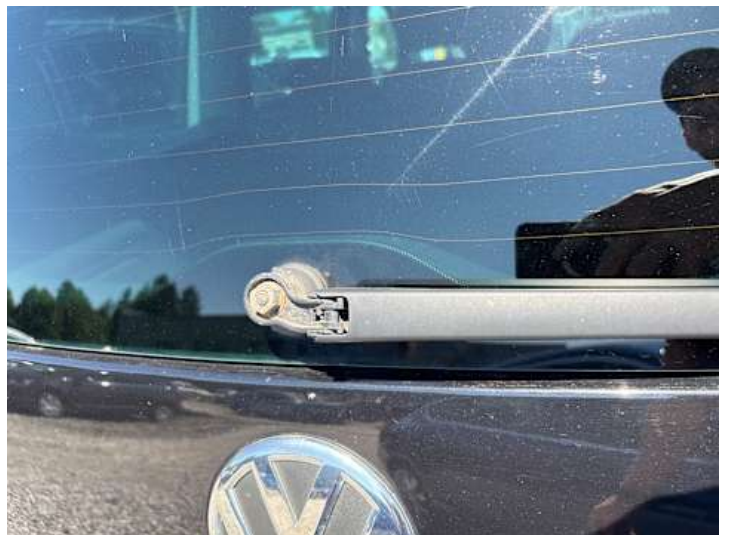
Heckklappe (Anderer Schaden): Abdeckung fehlt
