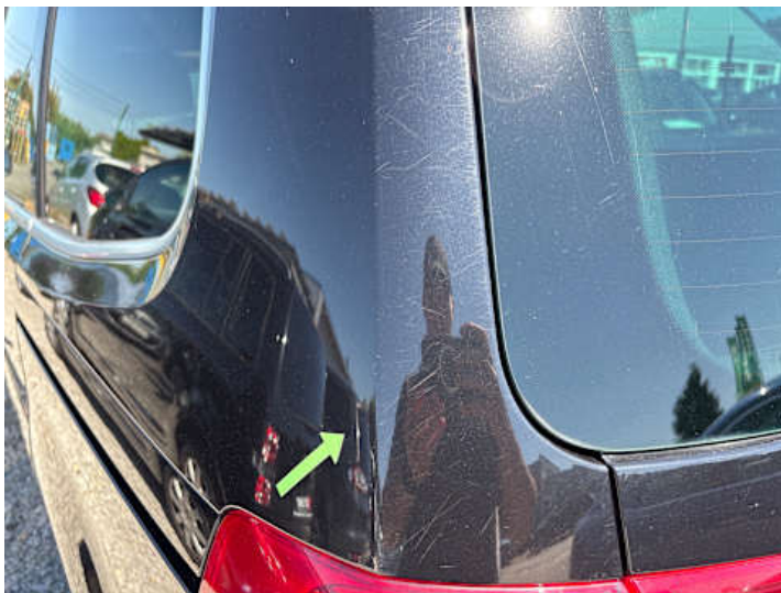
Seitenteil hinten links (Kratzer, Delle)
