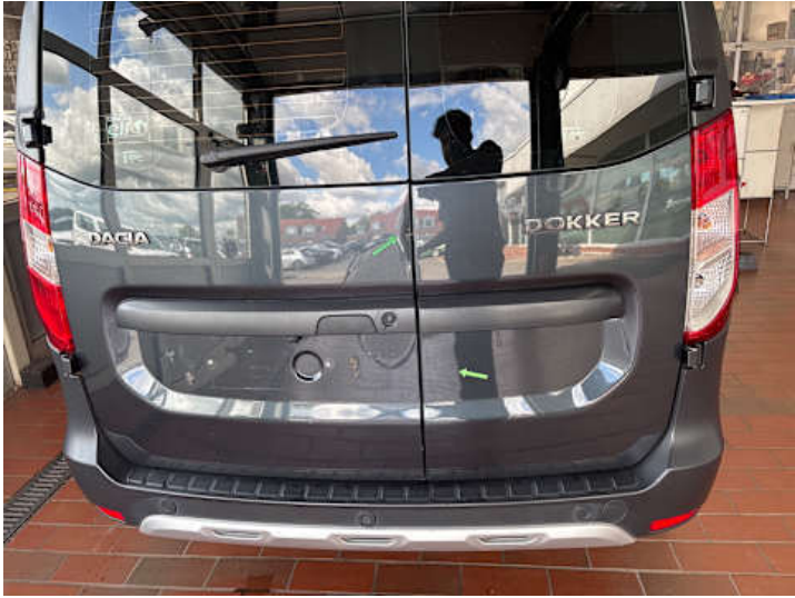
Heckklappe (Kratzer, Verformung)
