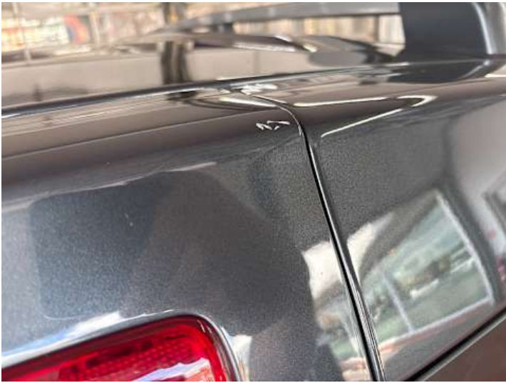
Heckklappe (Kratzer, Verformung)
