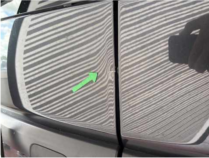
Heckklappe (Kratzer, Verformung)
