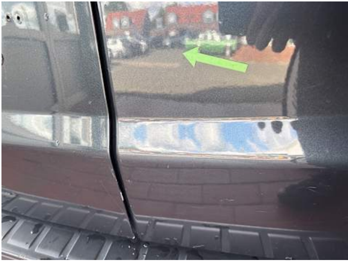
Heckklappe (Kratzer, Verformung)
