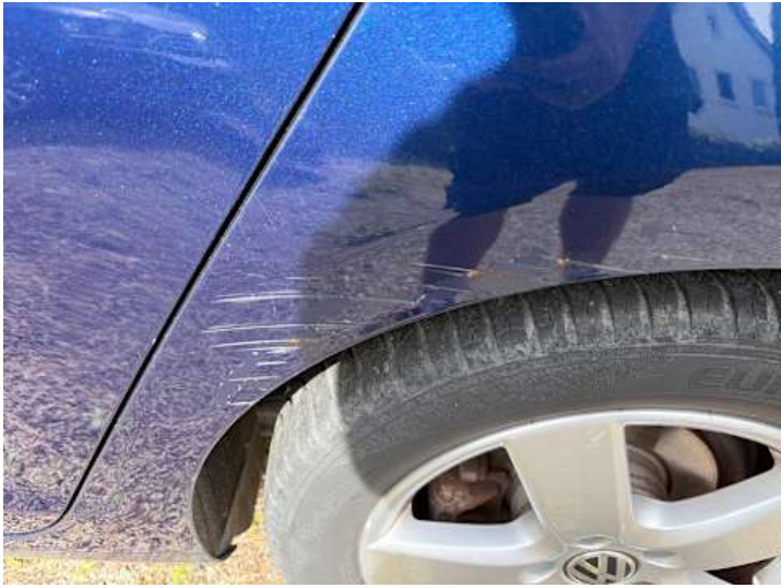
Seitenteil hinten links (Kratzer, Rost)
