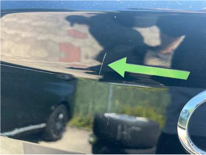
Heckklappe (Lackschaden, Kratzer)
