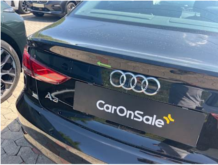
Heckklappe (Lackschaden, Kratzer)
