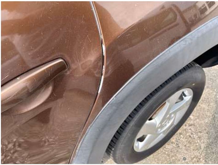
Seitenteil hinten links (Lackschaden)
