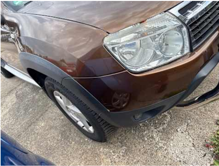
Stoßstange vorne (Kratzer, Spaltmaße ungenau)
