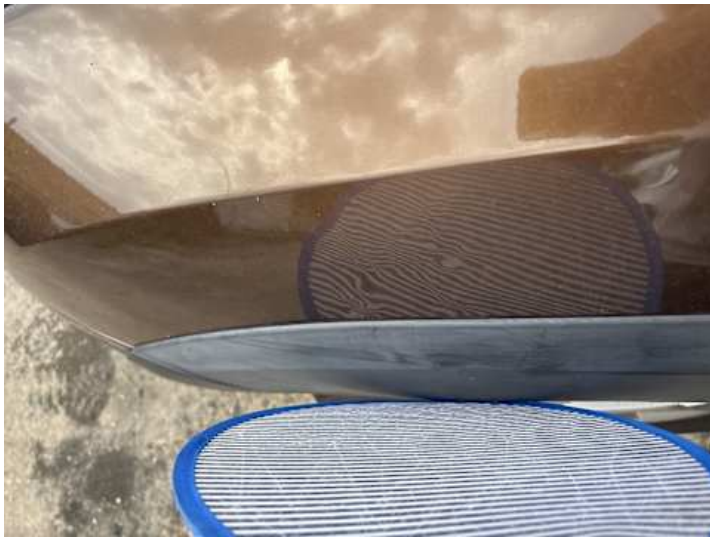
Kotflügel vorne links (Delle)
