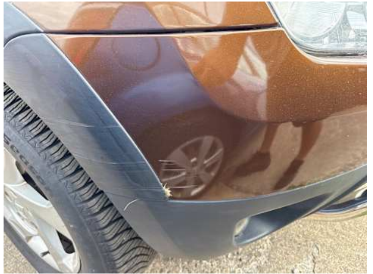
Stoßstange vorne (Kratzer, Spaltmaße ungenau)
