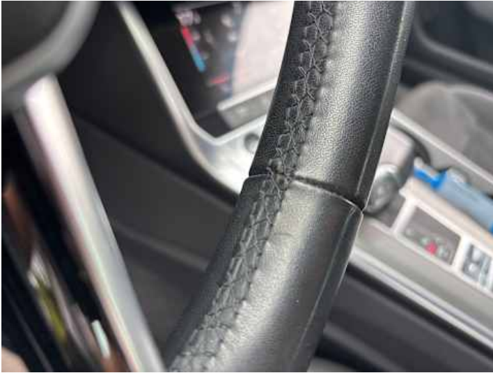
Innenraum (Verschmutzung, Verschleiß)
